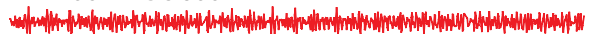
Abb. 5.3 Jede der Wellen ist aus fünf Sinuswellen zusammengesetzt. Der \lambda -Bereich der Teilwellen ist oben sehr klein, nämlich 2 % von 400 nm, und nimmt nach unten hin bis auf 100 % zu.
