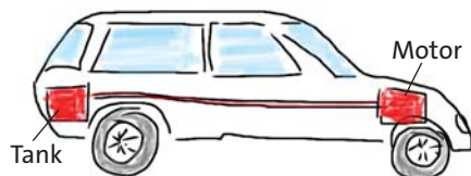
Abb.1.2 Die Energie gelangt mit dem Energieträger Benzin vom Tank zum Motor.
