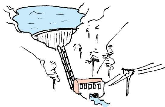
Abb. 5.10 Wasserkraftwerk. Beim Herunterfließen in den Rohren nimmt das Wasser Energie aus dem Schwerfeld auf. In der Turbine gibt es die Energie wieder ab.
