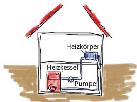
Abb.1.1 Die Energie geht mit dem Energieträger „warmes Wasser“ vom Heizkessel zum Heizkörper.
