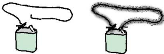
Abb. 28.18 Umgebung einer elektrischen Leitung in zwei verschiedenen Zuständen. Links: ohne magnetisches Feld; rechts: mit magnetischem Feld
