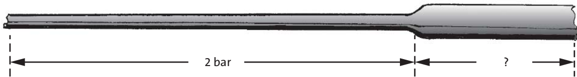
Abb. 2.11 Ist die Druckdifferenz zwischen der Stelle, wo das Rohr weiter wird, und rechtem Ende des Rohrs größer oder kleiner als 2 bar?
