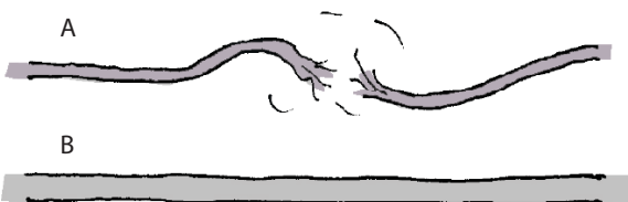
Abb. 3.59 Die Querschnittsfläche von Seil B ist doppelt so groß wie die von A Seil A.
