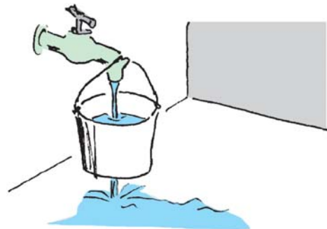
Abb. 3.29 Durch das Loch fließt genauso viel Wasser ab, wie aus dem Wasserhahn zufließt. Die Wassermenge im Eimer bleibt konstant.
