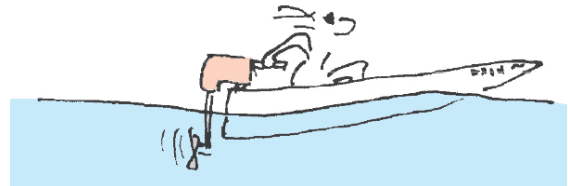
Abb. 3.26 Die Schraube pumpt Impuls aus dem Wasser ins Boot.
