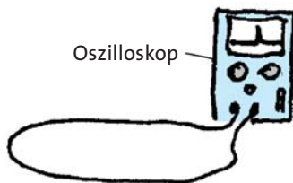
Abb. 28.20 Die Drahtschleife ist die Empfangsantenne. In der Empfangsantenne wird durch die ankommende Welle eine Spannung induziert. Die Spannung wird vom Oszilloskop angezeigt.
