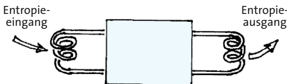
Abb. 10.7 Die Wärmepumpe hat einen Eingang und einen Ausgang für Entropie.
