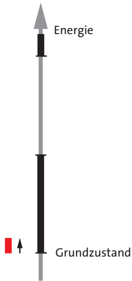
Abb. 31.17 Bei Normaltemperatur reicht die Energie der Bewegung der Atome in Metallen nur für leichte Verformungen aus.
