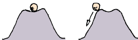
Abb. 7.56 Man braucht nur wenig Energie, um die Kugel über den Rand zu rollen.
