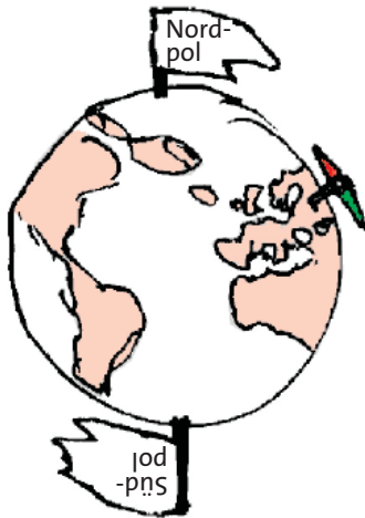
Abb. 18.48 Ein drehbar gelagerter Magnet stellt sich in Nord-Süd-Richtung ein.
