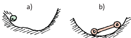
Abb. 7.53 (a) Die Kugel rollt an die tiefste Stelle der Mulde. (b) Das Fahrzeug pendelt sich so ein, dass es waagrecht steht
