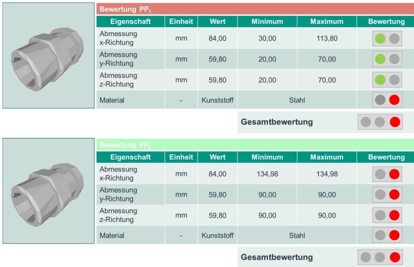
Abbildung 5.33: Bewertung der produktionsrelevanten Produkteigenschaften anhand aller gefundenen Bereiche PP n für Adapter 230021093 (Zwischenzustand 7)
