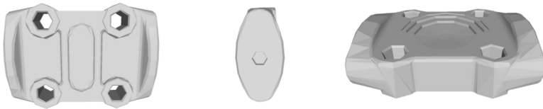
Abbildung 5.41: Funktionsflächen von Flansch 230036437 aus verschiedenen Perspektiven
