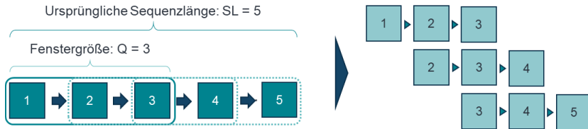
Abbildung 4.10: Vorgehensweise zur Bildung von Sequenzabschnitten über ein Sliding Window
