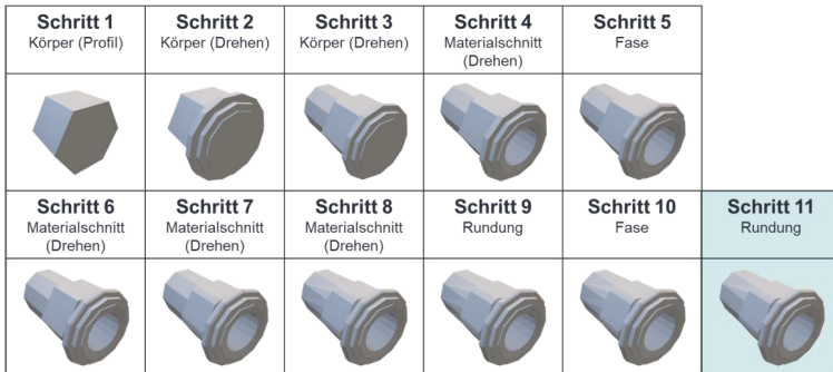
Abbildung 5.8: Sequenz der Zwischenzustände und KEs eines exemplarischen Adapters bestehend aus elf Schritten. Blau markiert ist der finale Zustand.
