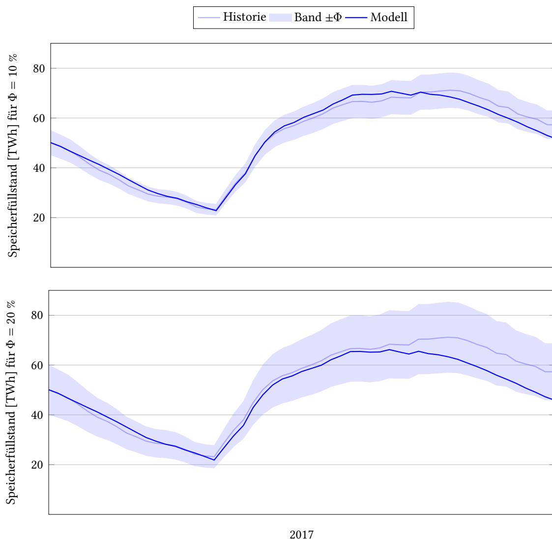
Abbildung 3.7.: Historischer und modellierter Speicherfüllstand der Speicherwasserkraftmodellierung in PowerACE für Norwegen für das Jahr 2017 mit einem "Atmungsfaktor" von \Phi = 10\% bzw. \Phi = 20\%
