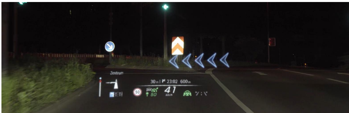
Abb. 1.2: Augmented Reality Head-up Display der Mercedes-Benz S-Klasse (W223)
