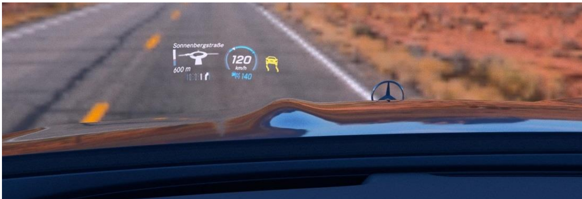
Abb. 1.1: Virtuelles Bild der Mercedes-Benz E-Klasse (W213) in ca. zwei Metern Entfernung
