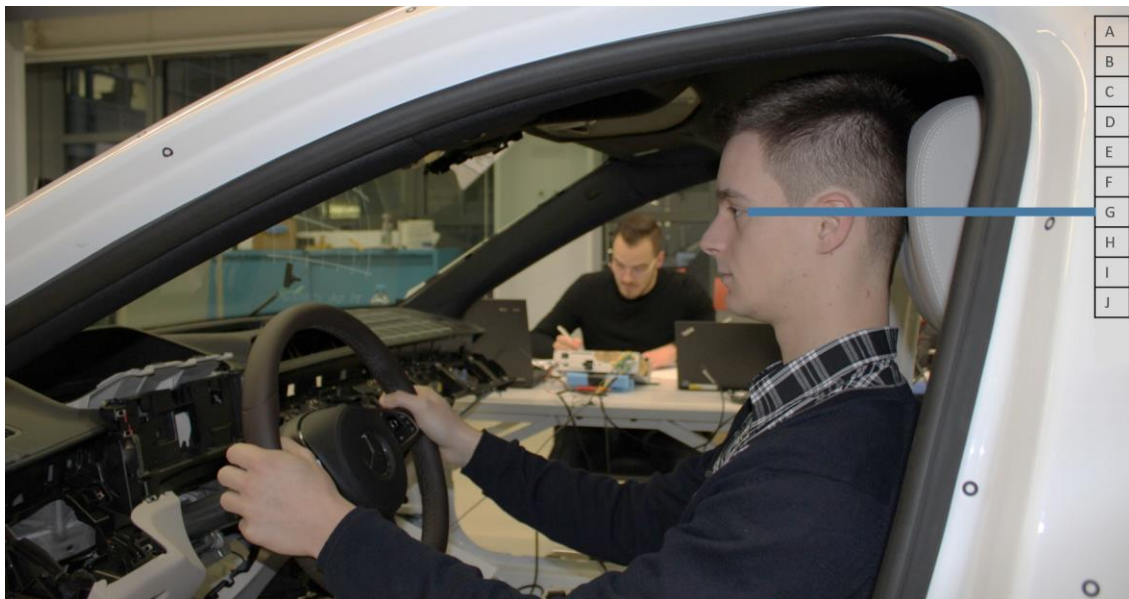
Abb. 4.24: Ablesen der Augenposition eines Probanden zum Abgleich mit Kamerapositionen am HUD Prüfstand
