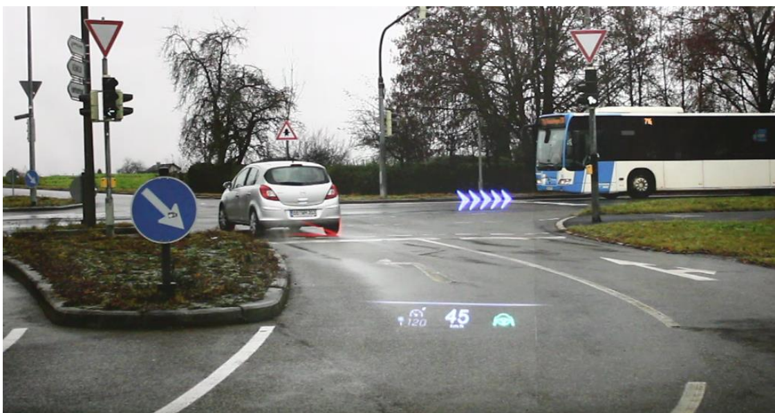
Abb. 4.20: Navigationshilfe des AR HUD - Abbiegepfeil auf der Leinwand aus perspektivischer Sicht der Proband:in
