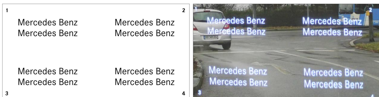
Abb. 4.18: Mercedes-Schriftzug in vier Quadranten als Testbild (Input) und virtuelles Bild (Output) des Versuchsträgers
