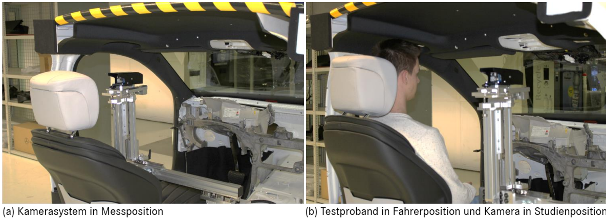
Abb. 4.11: Kamerasystem in Messposition (a); Testproband in Fahrerposition und Kamera in Studienposition (b)
