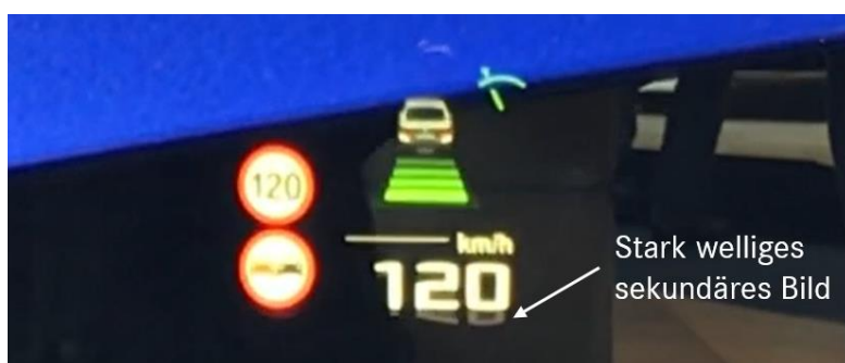
Abb. 5.7: Welliges sekundäres Bild durch Reflektion an einem metallisch beschichteten Polymer im Windschutzscheibenverbund
