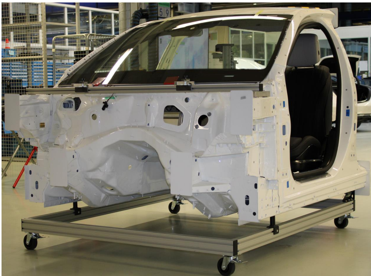
Abb. 4.2: Versuchsträger als Teil der Rohkarosse (A- bis B-Säule) der Baureihe W223
