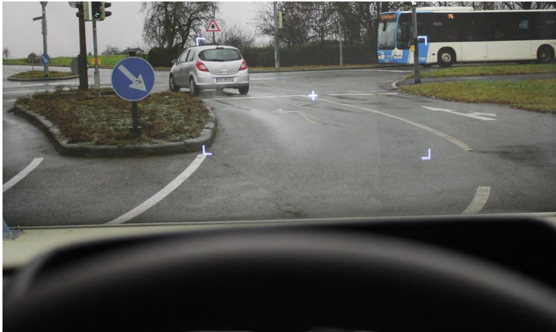
Abb. 4.23: Sicht der Proband:in aus dem Versuchsträger auf das virtuelle Testbild mit vier Rahmeneckpunkten zur Kontrolle der richtigen Sitzposition
