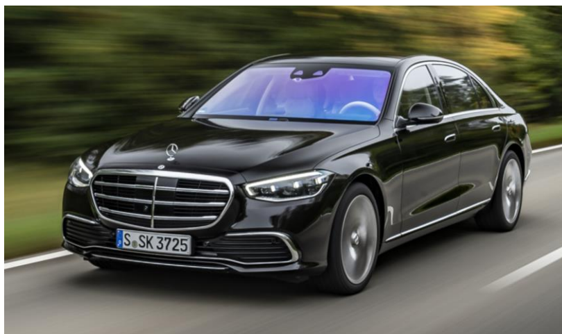
Abb. 5.5: Mercedes-Benz S-Klasse (BR223) mit metallisch beschichteter WSS für vollflächige Heizfunktion
