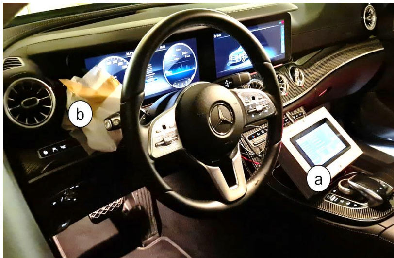
Abb. 5.17: Modifizierte Mercedes-Benz CLS-Klasse zur Anzeige individueller Testbilder unter Verwendung einer (a) Image Box und eines (b) HSVL Scaler
