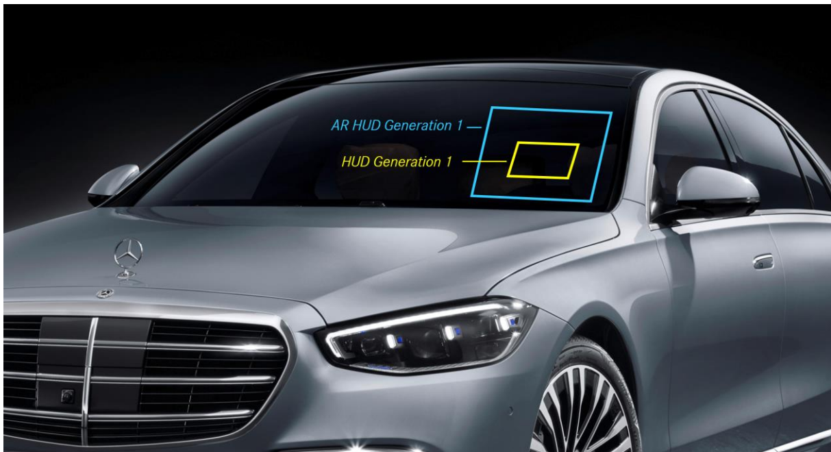
Abb. 4.1: Schematische Darstellung der Reflektionsfläche auf der WSS für verschiedene HUD Generationen
