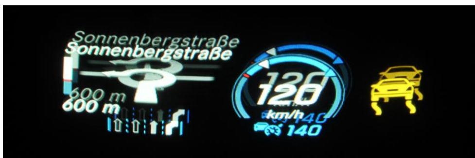
Abb. 5.16: Aufnahme eines virtuellen Bildes mit manipuliertem Doppelbild
