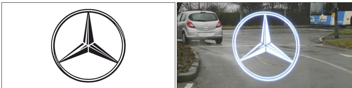
Abb. 4.17: Mercedes-Stern als Testbild (Input) und virtuelles Bild (Output) des Versuchsträgers
