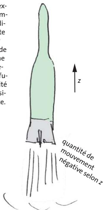
Les avions sont entraînés de manière similaire. Supposons qu'un avion vole dans le sens des  $x$  positifs. Avec l'hélice ou le turboréacteur, l'air que l'avion « collecte » à l'avant est chargé de quantité de mouvement négative et expulsé à l'arrière. L'avion reçoit la quantité de mouvement positive correspondante, Fig. 2.40.
