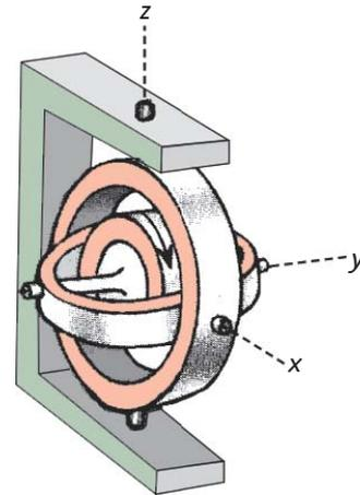
**Fig. 3.25** Suspension à cardan. La roue est complètement isolée du support : le moment cinétique ne peut circuler, ni suivant  $x$ , ni suivant  $y$ , ni suivant  $z$ .
