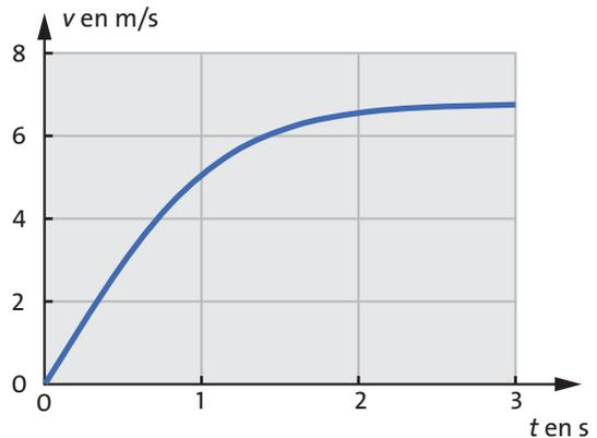
**Fig. 4.8** S'il y a frottement de l'air, la vitesse d'un corps qui tombe augmentera jusqu'à une vitesse limite.
