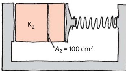
Fig. 2.72 Les courants de quantité de mouvement dans K1 et K2 ont la même intensité. L'intensité du courant de quantité de mouvement par surface, c'est-à-dire la pression, dans K1 est plus élevée que dans K2.
