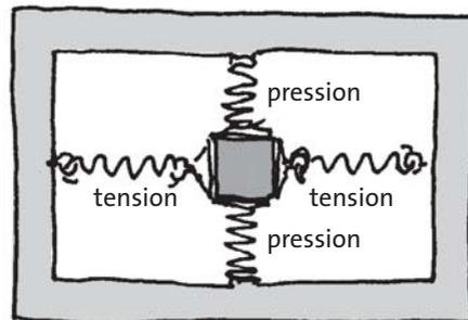
Fig. 2.77 Le bloc est soumis à de la pression dans la direction verticale et à de la tension dans la direction horizontale.
