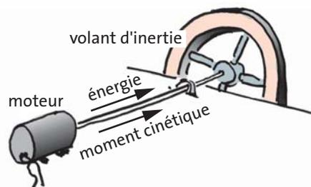
Fig. 5.13 Dans le volant d'inertie, le moment cinétique et l'énergie sont stockés.
