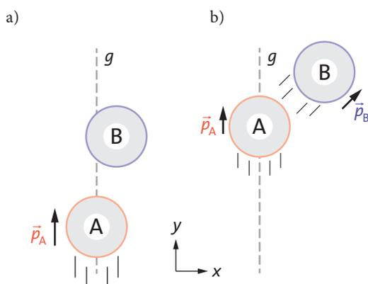
**Fig. 2.10** Avant la collision (a), A a seulement de la quantité de mouvement selon  $y$ , B n'a aucune quantité de mouvement ; après la collision (b), B n'aurait que de la quantité de mouvement selon  $x$  et A n'en aurait aucune. Un tel processus n'existe pas !
