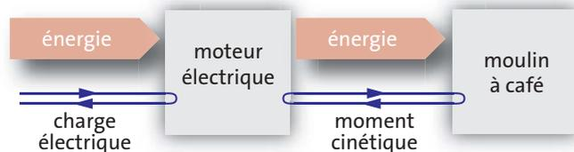
Fig. 5.7 Diagramme des flux du moulin à café de la Fig. 5.6
