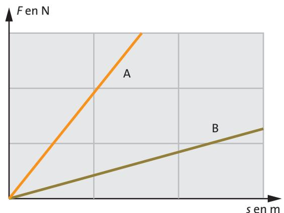
Fig. 2.55 La constante du ressort du ressort A est plus grande que celle du ressort B. Le ressort A est plus raide.
