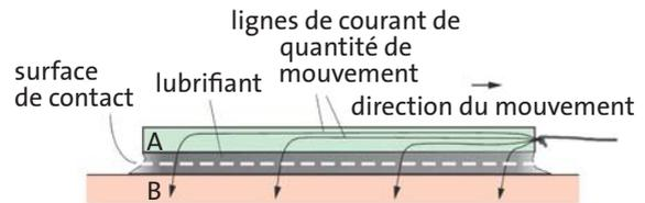
**Fig. 5.27** Pendant le processus de frottement, la quantité de mouvement dans la direction  $x$  circule du corps A au corps B. (sens des  $x$  positifs vers la droite)
