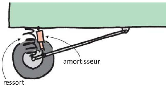
Fig. 5.29 Suspension de roue simplifiée avec un ressort et un amortisseur
