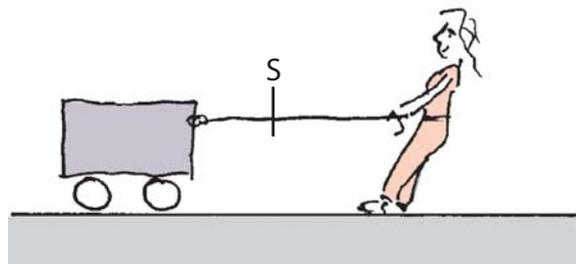
Fig. 2.34 Un courant de quantité de mouvement circule à travers la surface S. Par conséquent, la quantité de mouvement du chariot augmente.
