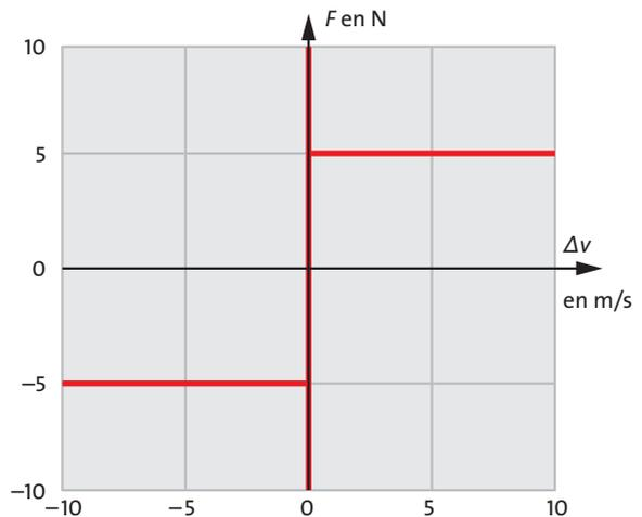
Fig. 5.34 Pour  $\Delta v = 0$ , la courbe caractéristique a une discontinuité.
