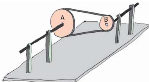
**Fig. 5.22** Entraînement par courroie. La roue B tourne plus vite que la roue A.
