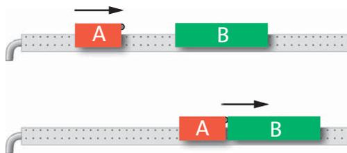
**Fig. 2.5** Si le pare-chocs est inélastique, les véhicules se déplaceront avec la même vitesse après la collision.
