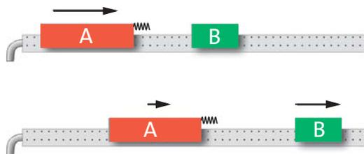
**Fig. 2.3** Si le corps A est plus lourd que le corps B, seulement une partie de sa quantité de mouvement sera transférée à B pendant la collision.
