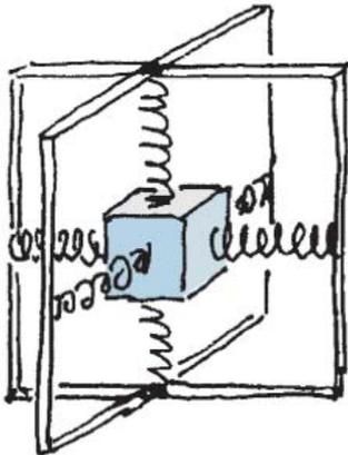
**Fig. 2.79** Les pressions peuvent être imposées dans trois directions qui sont perpendiculaires l'une de l'autre.
