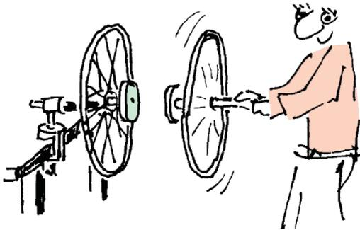
Fig. 3.4 Dès que les disques d'accouplement des deux roues sont en contact, le moment cinétique commence à être transféré de la roue de droite à celle de gauche.
