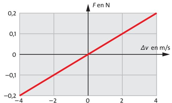
**Fig. 5.28** Courbe caractéristique pour le frottement visqueux : le courant de quantité de mouvement est proportionnel à la différence de vitesse des corps impliqués.
