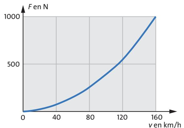
**Fig. 4.5** Intensité du courant de quantité de mouvement qui s'écoule au loin dans l'air en fonction de la vitesse pour une voiture typique
