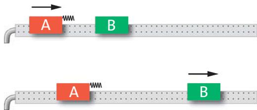
**Fig. 2.2** Lors de la collision, A transfère toute sa quantité de mouvement à B.
