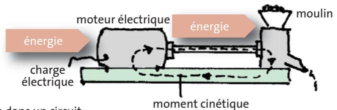
Fig. 5.6 Moulin à café. Le moment cinétique circule dans un circuit.
