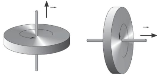
**Fig. 3.23** Bien que les deux volants identiques tournent avec le même nombre de tours par minute, ils ont des vitesses angulaires différentes et un moment cinétique différent.
