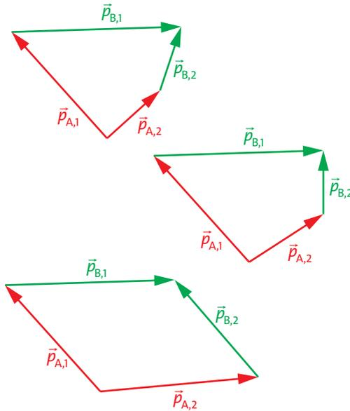
**Fig. 2.14** Bilan de quantité de mouvement pour différents processus de collision
