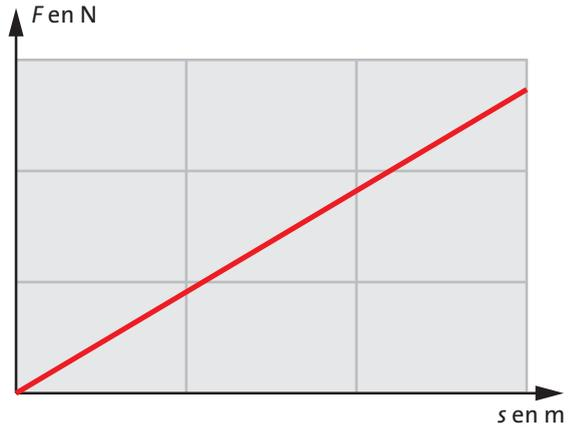
Fig. 2.54 Pour un ressort en acier, la relation entre l'intensité du courant de quantité de mouvement et l'extension est linéaire.
