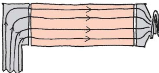
Fig. 2.71 Le courant de quantité de mouvement est réparti sur toute la section transversale du bloc.
