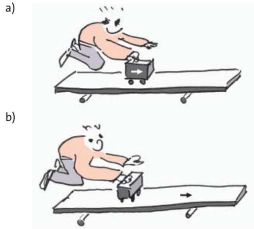
**Fig. 2.43** (a) Les roues sont des non-conducteurs pour la quantité de mouvement longitudinale. Aucune quantité de mouvement n'entre dans la planche. (b) Les roues sont des conducteurs pour la quantité de mouvement transversale. La quantité de mouvement entre dans la planche
