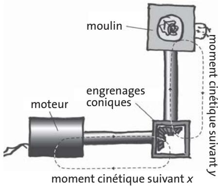
Fig. 3.30 Entraînement par engrenages coniques
