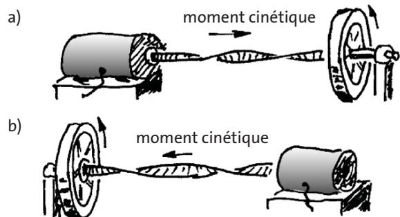
Fig. 3.20 (a) Le moment cinétique circule de la gauche vers la droite. (b) Le moment cinétique circule de la droite vers la gauche.
