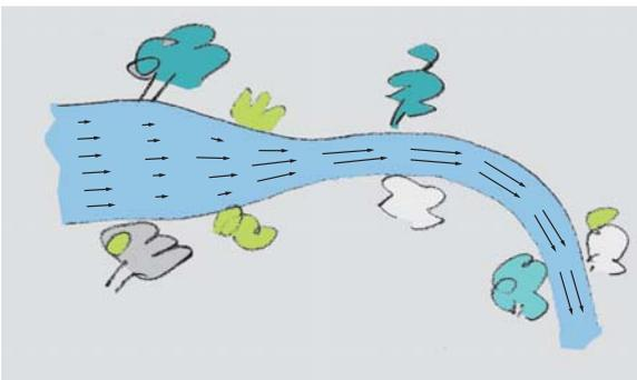
**Fig.1.7** Distribution de vitesse de l'eau dans une rivière, illustrée par des flèches vectorielles
