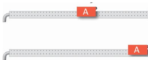
**Fig. 2.7** Pare-chocs inélastique. La Terre est le partenaire de la collision. Après la collision, les deux corps (corps A et Terre) ont la même vitesse, c'est-à-dire  $0 \text{ m/s}$
