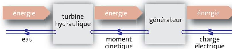
Fig. 5.8 Diagramme des flux d'une centrale hydroélectrique
