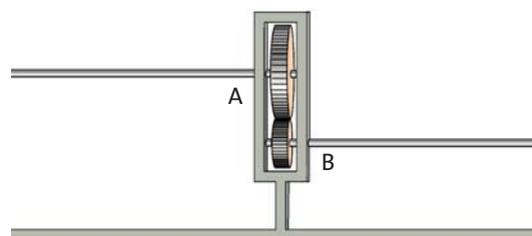
Fig. 5.20 Entraînement simple par engrenages
