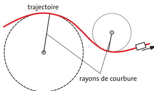
**Fig. 2.64** Trajectoire d'une voiture. Le rayon de courbure change chaque fois que la position du volant est modifiée
