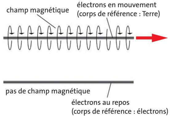
**Fig. 6.6** L'intensité du champ magnétique est nulle dans le référentiel dans lequel les électrons sont au repos.
