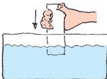
Fig. 2.82 L'eau ne peut être mise sous pression de cette manière. Elle s'échappe sur les côtés.
