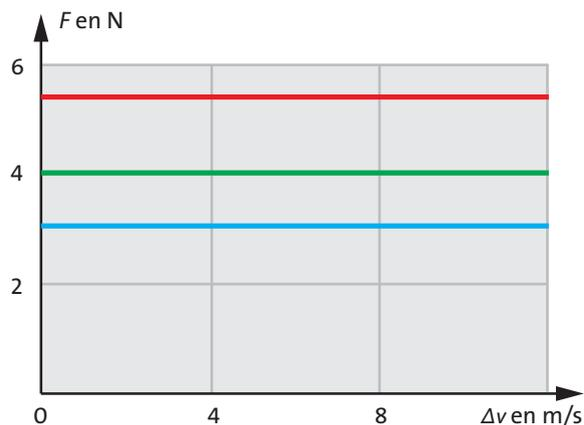
**Fig. 5.36** Courbes caractéristiques  $\Delta v$ - $F$  pour trois valeurs différentes du courant de mouvement transversal
