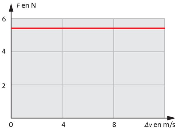
Fig. 5.32 Partie positive de la courbe caractéristique  $\Delta v$ - $F$  pour le frottement entre deux corps solides
