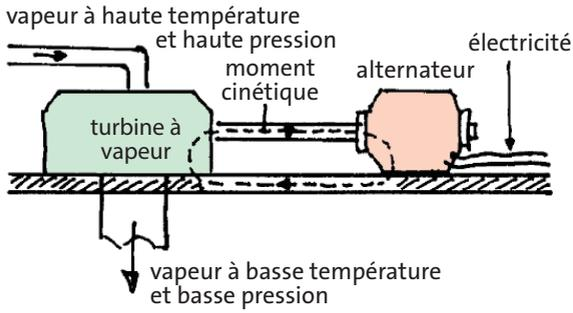
Fig. 3.29 Turbine et alternateur dans une centrale électrique. Le moment cinétique circule en circuit fermé.
