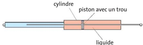
Fig. 5.30 Amortisseur. Si les deux extrémités sont déplacées l'une vers l'autre, le liquide sera pressé à travers le trou du piston.
