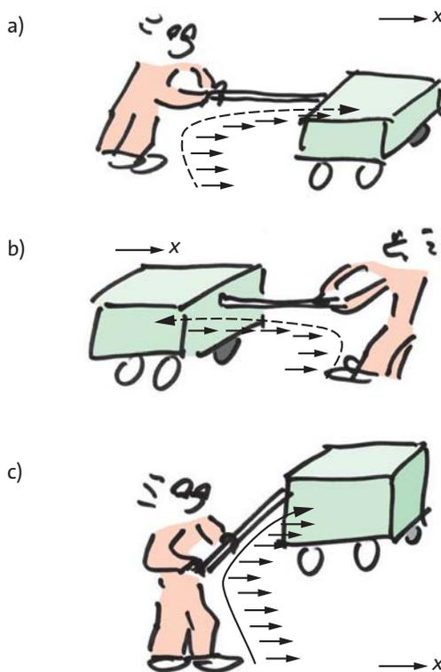
Fig. 2.26 (a) la quantité de mouvement suivant  $x$  circule dans la barre vers la droite (dans le sens des  $x$  positifs) (b) la quantité de mouvement suivant  $x$  circule dans la barre vers la gauche (dans le sens des  $x$  négatifs) (c) la quantité de mouvement suivant  $x$  circule dans la barre vers l'arrière (transversalement à la direction  $x$ ).
