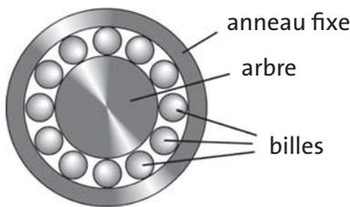
Fig. 3.17 Palier à roulement à billes (illustration simplifiée)
