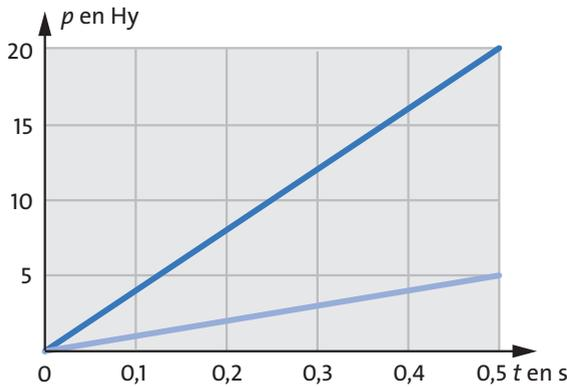
**Fig. 4.2** Quantité de mouvement en fonction du temps pour deux corps de masse différente qui tombent
