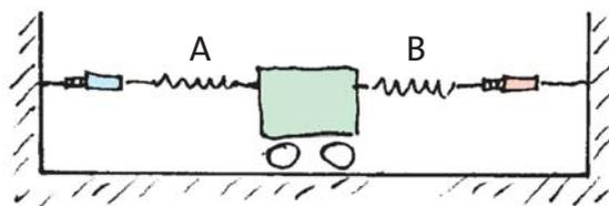
**Fig. 2.86** Le ressort A exerce une force vers la gauche sur le chariot, le ressort B exerce une force vers la droite. Comme ces forces ont la même intensité, la quantité de mouvement du chariot ne change pas.
