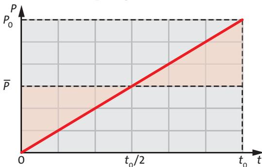
**Fig. 5.11** Le courant d'énergie augmente de zéro à  $P_0$  dans la période de  $t = 0$  à  $t_0$ . Le courant d'énergie moyen dans cet intervalle de temps est égal au courant d'énergie à l'instant  $t_0/2$ . L'écart en moins avant sera compensé par l'écart en plus après.
