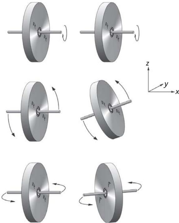
**Fig. 3.24** Le palier empêche la transmission d'une seule composante du moment cinétique (dans ce cas, la composante suivant  $x$ ).
