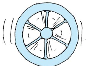
**Fig. 3.15** Volant d'inertie : la masse est répartie loin de l'axe.
