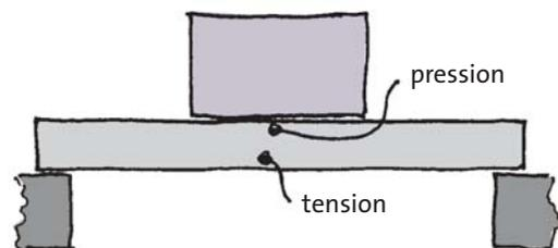
**Fig. 2.81** Il y a de la pression selon la direction horizontale dans la partie supérieure de la poutre et de la tension dans la partie inférieure.
