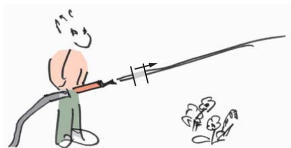
Fig. 2.38 La quantité de mouvement d'une portion de l'eau se déplace avec cette portion : courant convectif de quantité de mouvement.
