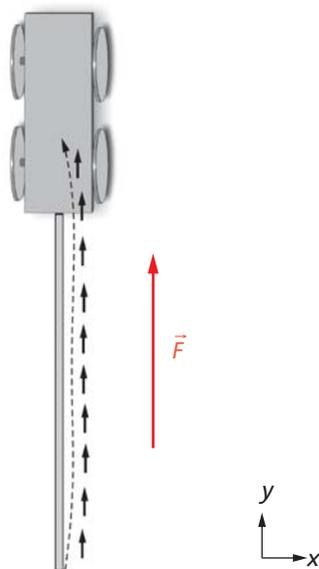
Fig. 2.37 De la quantité de mouvement suivant y circule vers le chariot à travers la barre.
