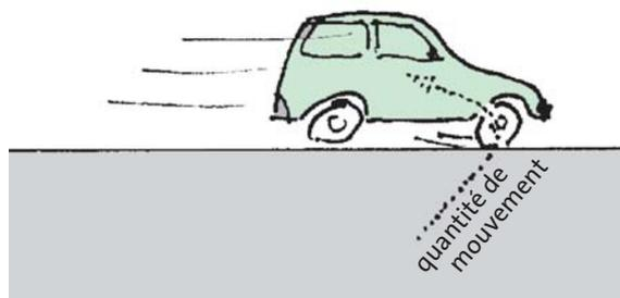
Fig. 2.19 Le moteur de la voiture pompe la quantité de mouvement de la Terre vers la voiture.
