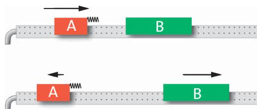
**Fig. 2.4** Le corps A est plus léger que B et libère plus de quantité de mouvement qu'il n'en a : sa quantité de mouvement devient négative.
