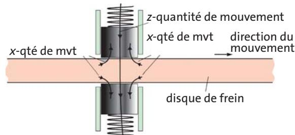
**Fig. 5.37** Frein à disque ou frein sur jante. Pour le freinage, un courant de quantité de mouvement suivant  $z$  est envoyé à travers le disque de frein de haut en bas. Cela provoque un courant de quantité de mouvement suivant  $x$  sortant du disque.
