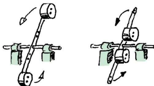
**Fig. 3.14** Les deux haltères ont la même masse, mais le moment d'inertie de l'haltère à gauche est supérieur à celui de l'haltère à droite.
