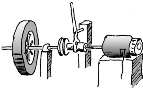
Fig. 3.18 La liaison entre le moteur et le volant d'inertie peut être interrompue à l'aide de l'embrayage.
