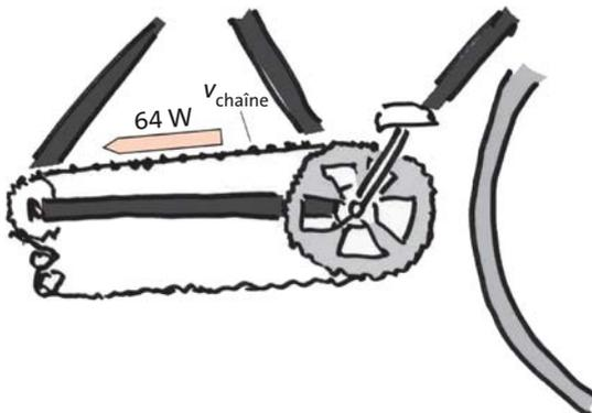
**Fig. 6.7** Le vélo comme corps de référence : un courant d'énergie de 64 W (flèche grise) parcourt la chaîne de droite à gauche.
