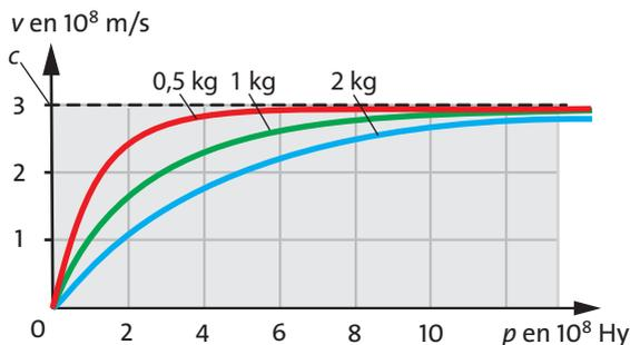
**Fig. 7.3** Dépendance de la vitesse à la quantité de mouvement pour des corps avec une masse au repos de 0,5 kg, 1 kg et 2 kg. Pour de grandes valeurs de la quantité de mouvement, la vitesse de tous les corps approche la vitesse terminale  $c$ .
