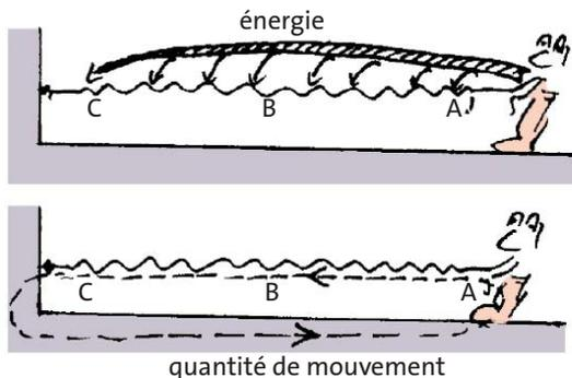
Fig. 5.10 Lorsque le ressort est étiré, de l'énergie pénètre dans le ressort par l'extrémité droite.
