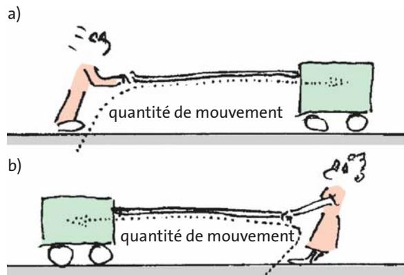
**Fig. 2.21** La quantité de mouvement est pompée dans le chariot depuis la Terre. (a) La quantité de mouvement circule dans la barre vers la droite. (b) La quantité de mouvement circule dans la barre vers la gauche.
