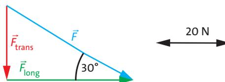
**Fig. 2.47** Décomposition d'un courant de quantité de mouvement d'une corde en une composante longitudinale et une composante transversale
