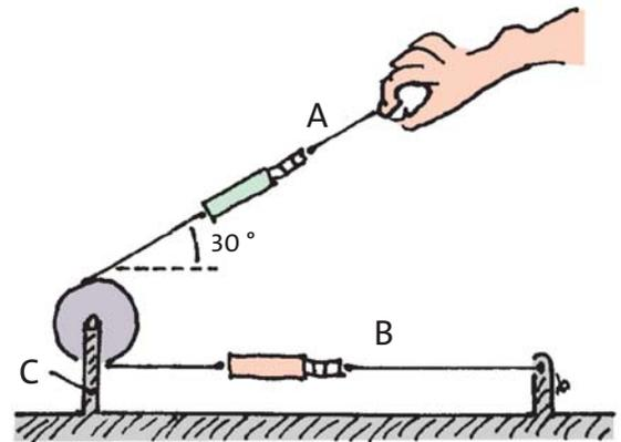
Fig. 2.68 Les courants de quantité de mouvement dans les cordes A et B ont la même amplitude mais différentes directions.
