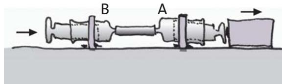
**Fig. 2.41** De la quantité de mouvement s'écoule à travers l'air du cylindre A dans le piston et plus loin dans le bloc.
