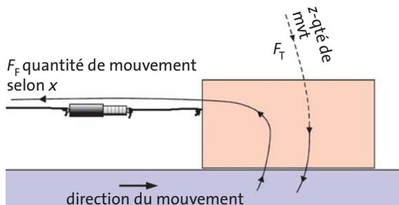
**Fig. 5.35** Le courant de quantité de mouvement suivant  $x$  traversant la corde est proportionnel au courant de quantité de mouvement suivant  $z$  qui arrive via le champ gravitationnel.
