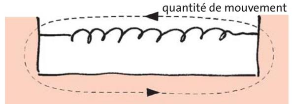
Fig. 2.30 Circuit de quantité de mouvement sans pompe
