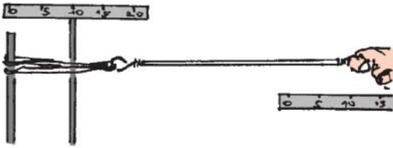
Fig. 2.52 Une corde élastique est étalonnée avec des unités d'anneaux élastiques.
