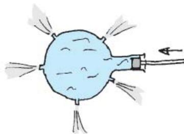
Fig. 2.84 Puisqu'il y a une pression dans toutes les directions, l'eau gicle dans toutes les directions.
