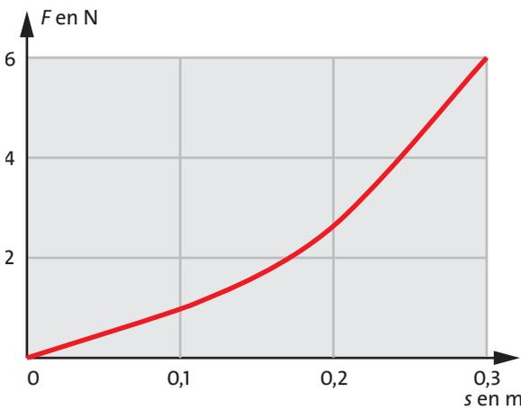
Fig. 2.53 Courbe d'étalonnage de la corde élastique : l'intensité du courant de quantité de mouvement est tracée en fonction de l'extension  $s$  de la corde.
