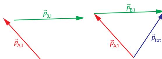
**Fig. 2.12** Les deux vecteurs de quantité de mouvement avant la collision (indice 1), sont additionnés vectoriellement pour obtenir la quantité de mouvement totale (indice tot).
