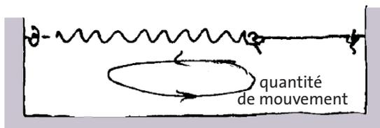
**Fig. 5.3** Un courant de quantité de mouvement circule mais aucun courant d'énergie.
