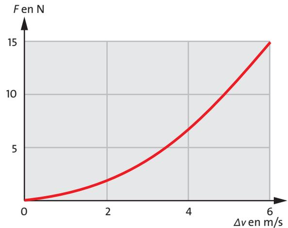
Fig. 5.38 Courbe caractéristique  $\Delta v$ - $F$  pour le frottement turbulent
