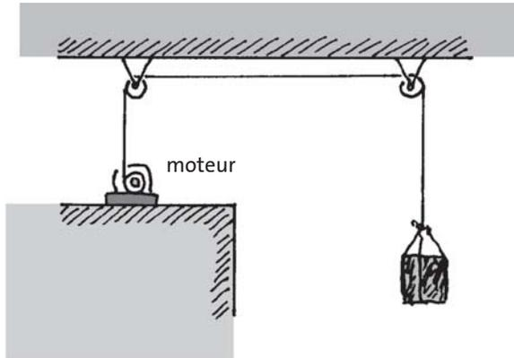
Fig. 2.65 Le moteur tire une charge vers le haut. La corde passe sur deux poulies.
