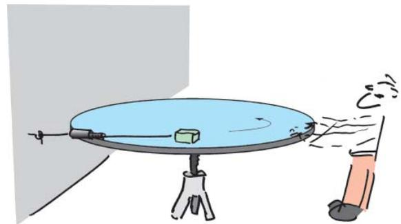
Fig. 5.31 Willy fait tourner la table. Le courant de quantité de mouvement entre le bloc et la table est indépendant de la différence de vitesse.
