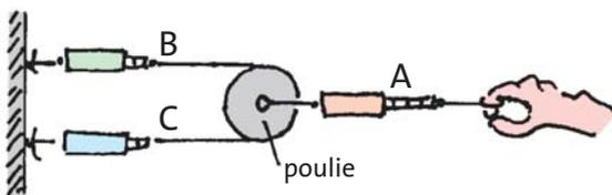
Fig. 2.66 Le courant de quantité de mouvement qui circule à travers la corde A est divisé dans la poulie en deux courants égaux.
