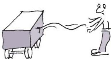
**Fig. 2.45** Aucune quantité de mouvement dont le vecteur est transversal à la corde ne peut circuler à travers la corde.
