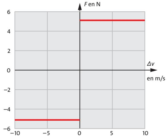
Fig. 5.33 Partie positive et négative de la courbe caractéristique  $\Delta v$ - $F$  pour le frottement entre deux corps solides
