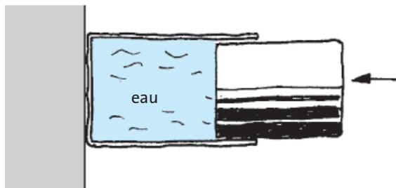
Fig. 2.83 Le piston est soumis à la pression seulement dans la direction horizontale, l'eau est sous pression dans toutes les directions.
