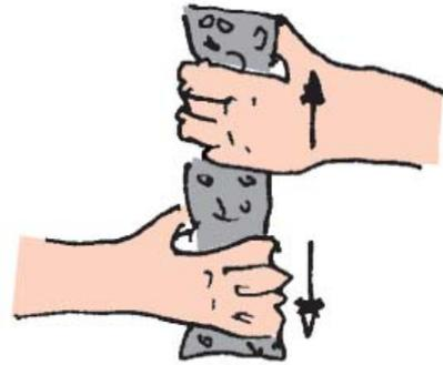
Fig. 2.76 L'intérieur de l'éponge est soumis à une contrainte de tension dans la direction verticale et à une contrainte de compression dans une direction horizontale.
