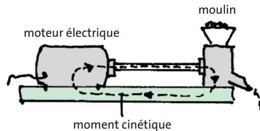
**Fig. 3.28** Moulin à café. Le moment cinétique circule en circuit fermé.
