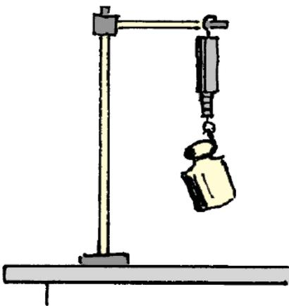
Fig. 4.1 Le dynamomètre indique qu'un courant de quantité de mouvement s'écoule du corps suspendu et vers le haut. Cette quantité de mouvement s'est écoulée à l'intérieur du corps à travers le champ gravitationnel.
