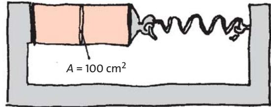
**Fig. 2.73** Le bloc est soumis à une contrainte de tension, la pression est négative.
