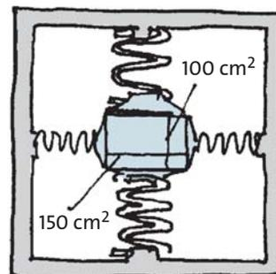
Fig. 2.78 Les pressions dans les directions horizontale et verticale sont différentes.
