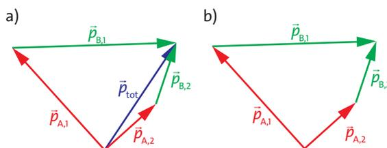
**Fig. 2.13** (a) Le vecteur somme des quantités de mouvement après la collision (indice 2) est égal à la quantité de mouvement totale. (b) Le vecteur somme des quantités de mouvement avant la collision est égal à celui après la collision.
