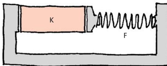
Fig. 2.70 Le bloc K est soumis à une contrainte de compression.
