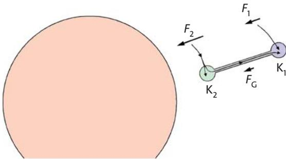
Fig. 4.19 Dans  $K_1$ , moins de quantité de mouvement s'écoule via le champ gravitationnel que dans  $K_2$ . De la quantité de mouvement doit donc s'écouler de  $K_2$  vers  $K_1$ .
