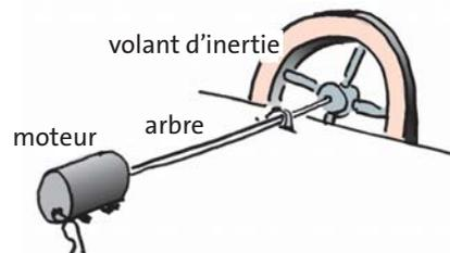
Fig. 3.16 Le moment cinétique circule à travers l'arbre, du moteur vers le volant d'inertie.
