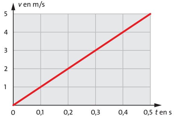
**Fig. 4.3** La vitesse d'un corps en chute libre augmente linéairement en fonction du temps.
