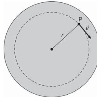
**Fig. 2.60** Le point P d'un corps en rotation se déplace sur une trajectoire circulaire.
