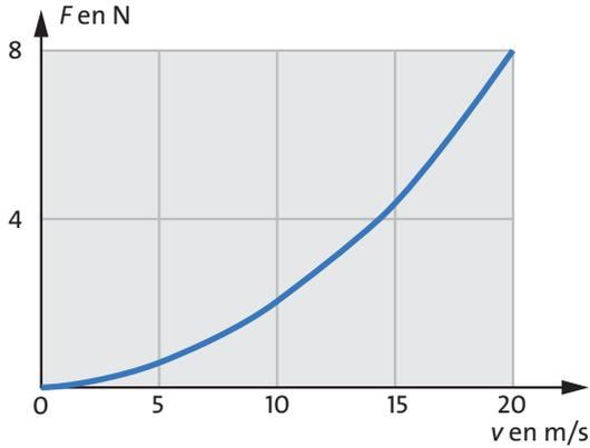
**Fig. 4.6** Intensité du courant de quantité de mouvement qui s'écoule au loin dans l'air en fonction de la vitesse pour une sphère de diamètre 30 cm
