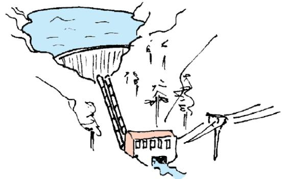
**Fig. 5.16** Centrale hydroélectrique. L'eau coule vers le bas dans les conduites et tire ainsi de l'énergie du champ gravitationnel.
