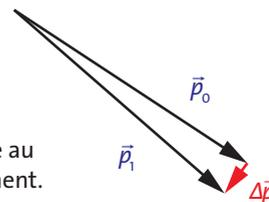
La quantité de mouvement additionnelle  $\Delta \vec{p}$  est perpendiculaire à la direction du mouvement (« quantité de mouvement transverse »).
