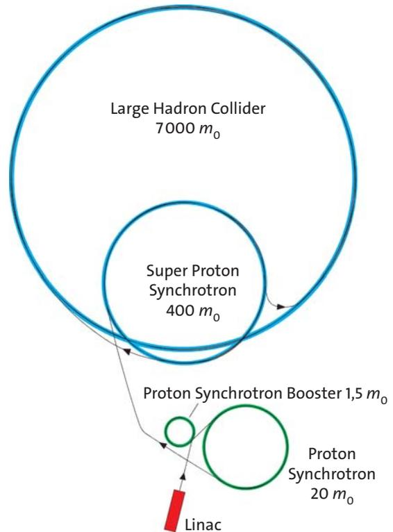
**Fig. 7.8** Le système de l'accélérateur LHC au CERN. Le grand anneau a une circonférence de 27 km. Le système est situé dans un tunnel sous la surface de la Terre. Ne sont pas représentés :
