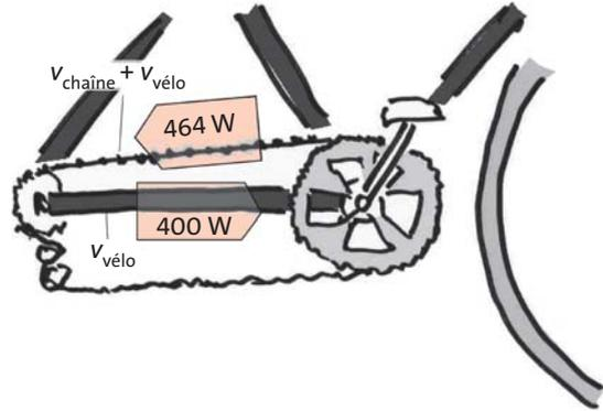
**Fig. 6.8** La Terre comme corps de référence : un courant d'énergie de 464 W parcourt la chaîne vers la gauche. 400 W circulent dans le cadre du vélo vers la droite.
