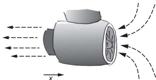
**Fig. 2.40** Le moteur à réaction charge l'air qu'il aspire à l'avant avec de la quantité de mouvement négative en  $x$ . L'avion reçoit la quantité de mouvement positive correspondante.
