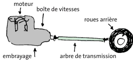
Fig. 3.19 L'embrayage de la voiture est utilisé pour interrompre la connexion entre le moteur et la boîte de vitesses.
