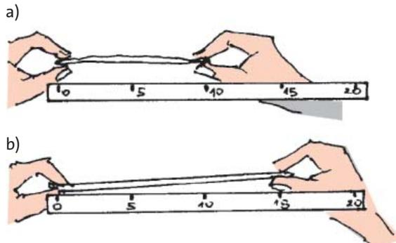
Fig. 2.51 Définition d'une unité pour l'intensité de courant de quantité de mouvement. (a) L'élastique est déroulé mais non étiré. (b) L'élastique est étiré de 5 cm.
