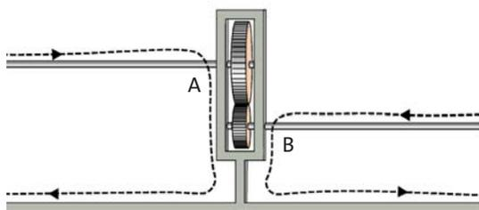
**Fig. 5.21** Le moment cinétique dans les arbres A et B circule dans des directions opposées.
