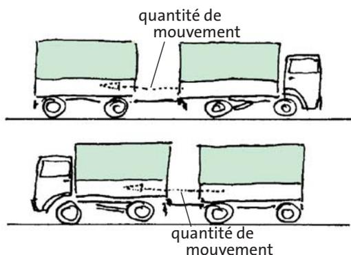
**Fig. 2.27** Un camion circule une fois vers la droite (a) et une fois vers la gauche (b). Les deux fois, la barre d'attelage est soumise à une contrainte de traction et les deux fois la quantité de mouvement suivant  $x$  circule dans le sens des  $x$  négatifs.
