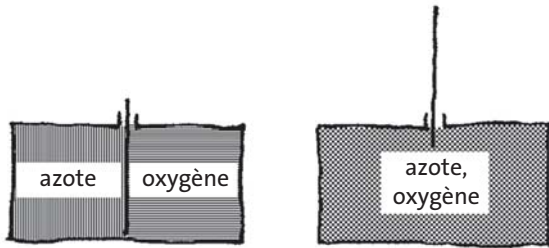
Fig. 2.19 Le processus est irréversible. De l'entropie est produite lorsque des gaz sont mélangés.
