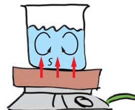
Fig. 8.5 Chauffage par le bas : il y a convection. Ce « brassage » assure une stratification indifférente.
