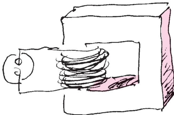
Fig. 3.18 « Transformateur » sans bobine secondaire. Si un courant alternatif circule dans la bobine (primaire), la magnétisation dans le noyau de fer change selon une fonction sinusoïdale.
