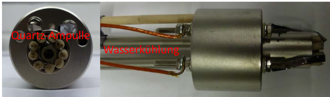
Abbildung 3.4: Front-(links) und Längsansicht(rechts) einer verwendeten Knudsenquelle ohne Abschirmung. Die Quartz-Probenvorlage wird durch die Korundisolierung fixiert. Rückseitig befinden sich die Zuleitungen für Heizstrom und Wasserkühlung. Im Betrieb wird der vordere Teil zusätzlich durch einen Edelstahlschild abgeschirmt und mit einem beweglichen Verschluss versehen.
