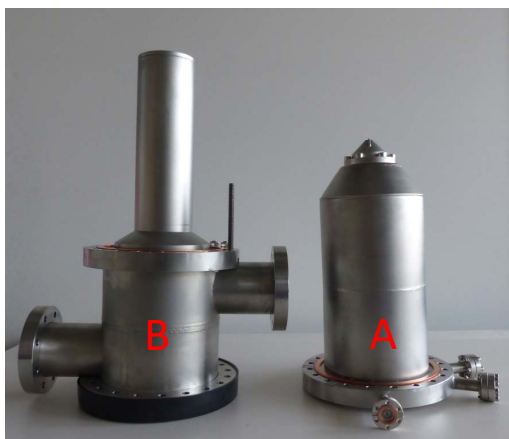
Abbildung 9.10: Technische Zeichnung, oben, und tatsächliche Ausführung des getesteten Reaktors. Hülle A stellt die erste Pumpstufe und äußere Abschirmung des QMS dar, an welcher ebenfalls die Gasdüsen zur Reaktanddosierung angebracht sind. B ist dementsprechend die innere Abschirmung, welche das QMS umschließt und separat evakuierbar ist. Gasleitungen und Hüllen sind aus Edelstahl gefertigt.
