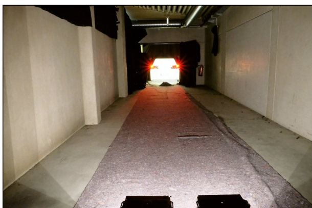
Bild 4-2 Nachgestellte Tag-Situation aus Probandensicht für die photopische Bedingung mit eingeschalteter Bremsleuchte
