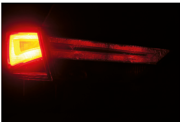
Bild 4-10 Schlussleuchte der Glühlampen-Version ausschließlich im Kotflügelsegment
