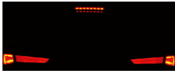
Bild 4-6 Signalbild der Seat Leon Heckleuchte mit aktivierter Bremsleuchte in der Glühlampenversion
