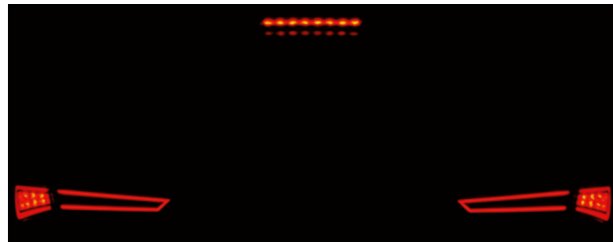
Bild 4-7 Signalbild der Seat Leon Heckleuchte mit aktivierter Bremsleuchte in der LED-Version
