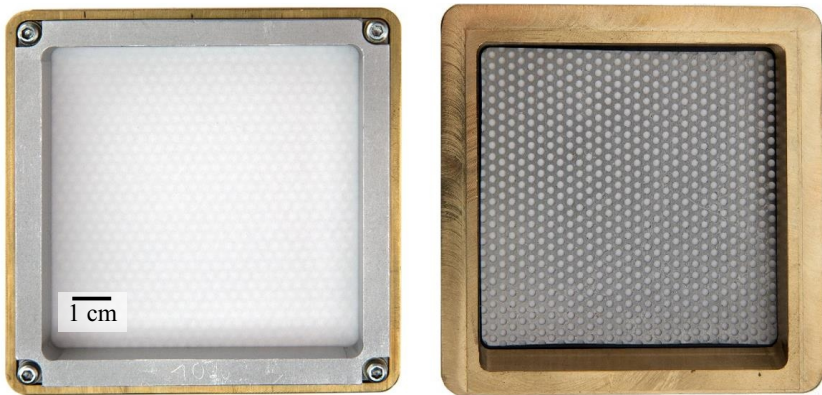
Abbildung 2.5: Filterhalterung mit Medium und Stützgitter. Links: Anströmseite, rechts: Abströmseite.
