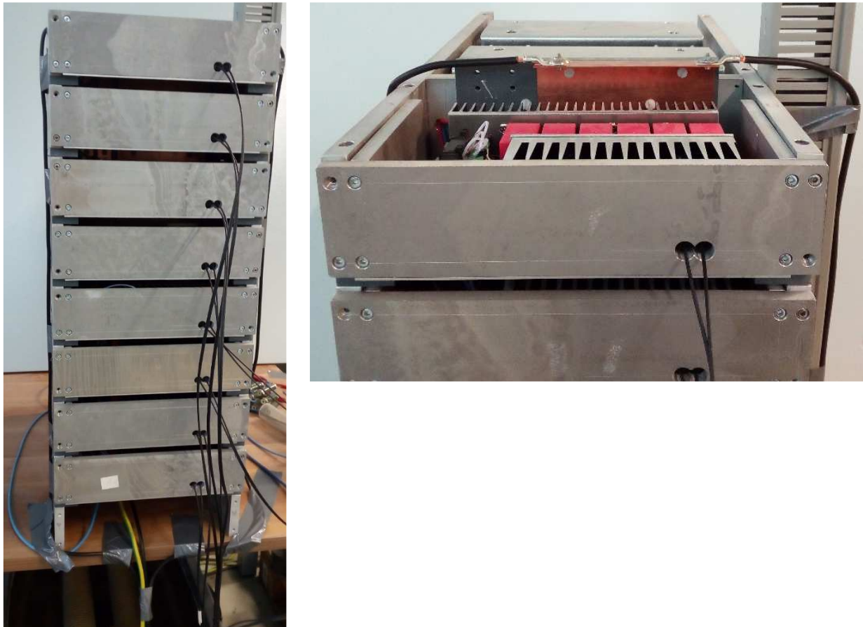
Bild 6: 8-stufiger Marxgenerator in der Verschaltung mit unsymmetrischer Erdanbindung (links): Die Anschlussleitung am Generatorausgang oben am Gehäuse (Detail rechts) ist beidseitig des Gehäuses im jeweils gleichen Abstand zur inneren Stromschiene geführt und am Fußpunkt des Gehäuses mit der erdseitigen Leitung zur Lastimpedanz unterhalb des Generators gehäusemittig zusammengeführt.
