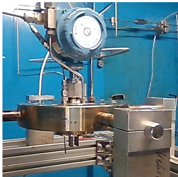
b) Foto mit modifiziertem Autoklavdeckel mit Dichtesensor
