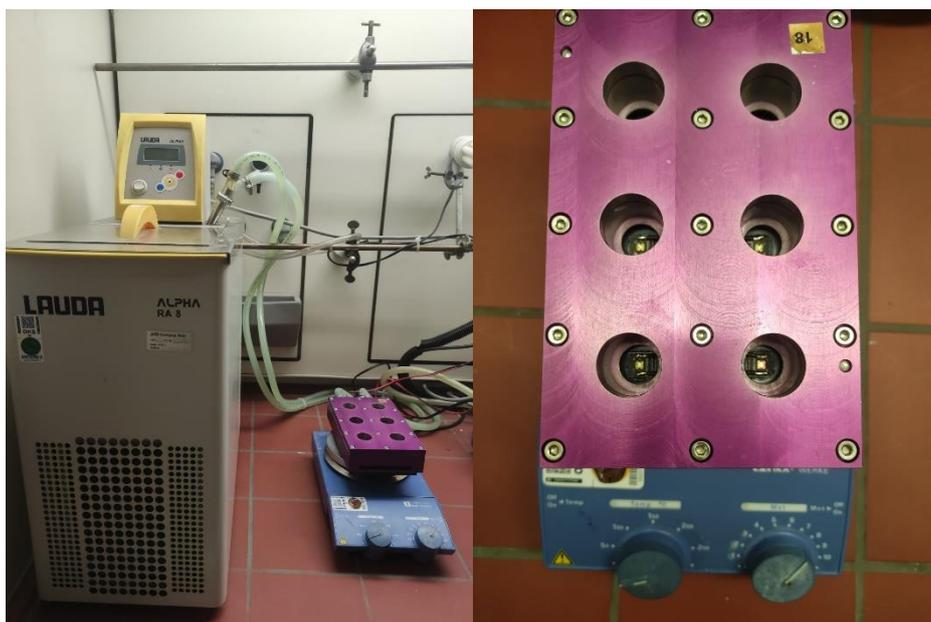
Abbildung 79: Belichtungsapparatur mit Thermostat, Kühlblock, Rührer und LEDs.
