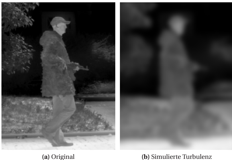
Abbildung 4.24: IR Beispielsequenz (a) originaler Einzelframe, (b) Frame mit simulierter Turbulenz
