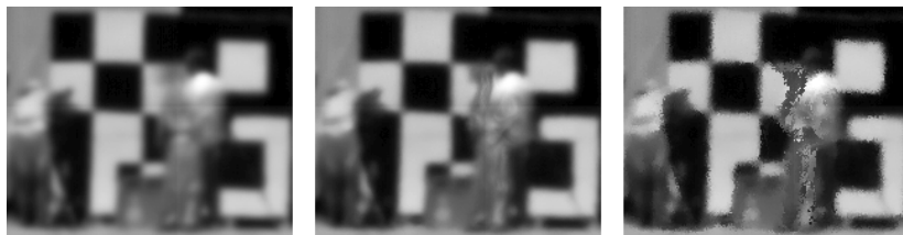
Abbildung 6.19: Vergleich von Mittelwert (links), Median (Mitte) und Modalbild (rechts), jeweils für 250 Frames der Sequenz
