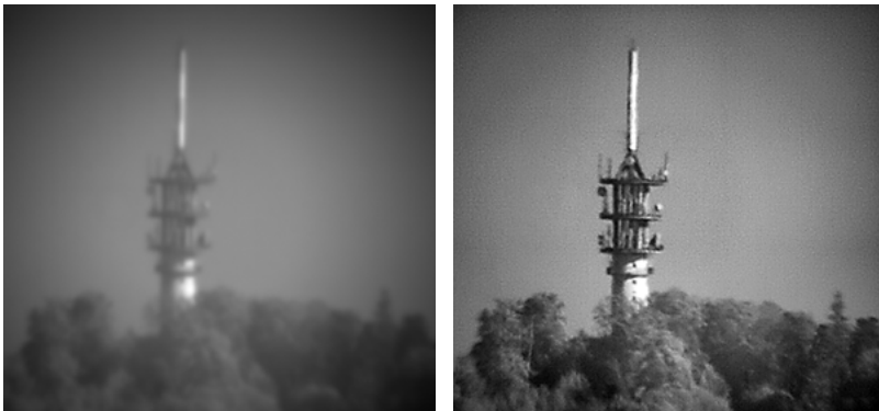
Abbildung 6.28: Beispiel für Turbulenzkorrektur. Links: Originalaufnahme, Objektdistanz ca. 27 km, bei schwacher Turbulenz; rechts: Korrekturergebnis, mehrstufige blinde Entfaltung, aus zwei registrierten Einzelbildern.
