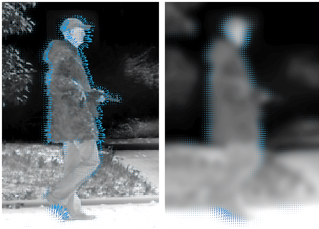
Abbildung 4.25: Beispiel für OF-Schätzung nach Horn-Schunck bei simulierter Turbulenz
