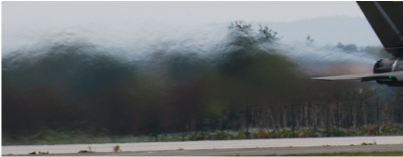
Abbildung 3.5: Extreme Turbulenz verursacht durch den Abgasstrahl eines Jet-Triebwerks
