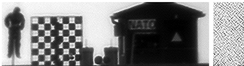
Abbildung 6.27: Schraffur-Artefakte infolge mehrstufiger Entfaltung mit unterschiedlichen Filtergrößen. Links: Beispielbild; rechts: Ausschnittsvergrößerung, zur Verdeutlichung mit Schärfungsfilter und Kontrastverstärkung.
