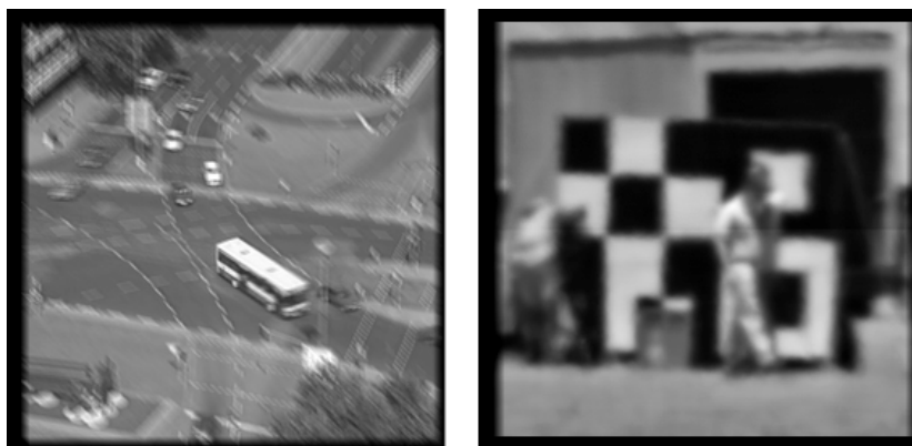
Abbildung 6.20: Demonstration des gerichteten Stapeleffekts. Links: Bildstapel auf die Bewegung des Busses ausgerichtet, Stapeltiefe: 6 Frames; rechts: Bildstapel für horizontale Bewegung, Stapeltiefe: 8 Frames.
