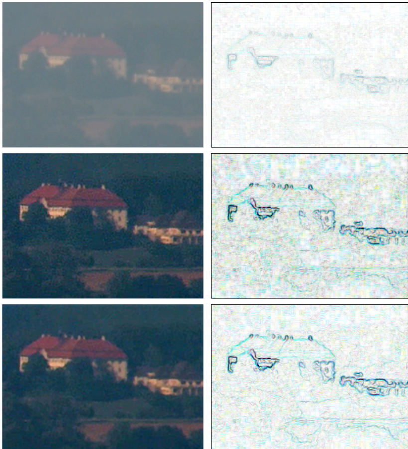
Abbildung 6.40: Beispiel für Bildvorverarbeitung in Farbbilddaten. Linke Spalte (v.o.n.u.): Originalfarbbild (Entfernung ca. 23 km), Resultat der Bildvorverarbeitungskette (Farbkontrastanhebung und Einzelbild-Deblurring), zusätzliche Rauschreduktion; rechte Spalte: korrespondierende Kantenbilder.
