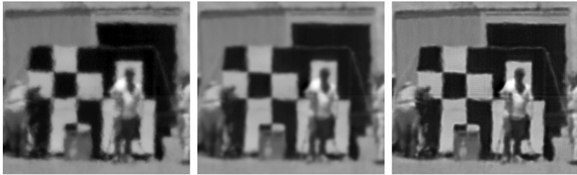
Abbildung 2.5: Beispielergebnis des CARES-Algorithmus. Links: Original-frame; Mitte: CARES-Korrekturergebnis; rechts: mit zusätzlicher blinder Entfaltung (mittels WIBD).
