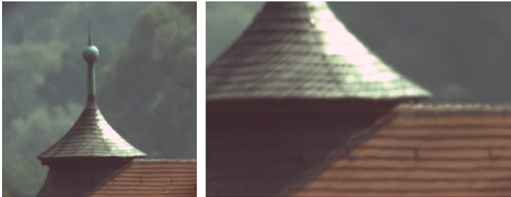
Abbildung 1.4: Beispiel für turbulenzbedingte Bildunschärfe. Links: Originalbild, rechts: Ausschnittsvergrößerung.
