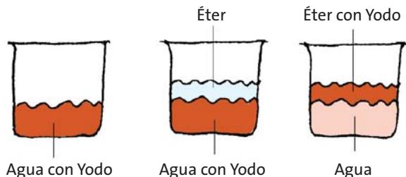
**Fig. 12.1** El yodo pasa del agua al éter, siguiendo el gradiente del potencial químico, pero en contra del gradiente de concentración.
