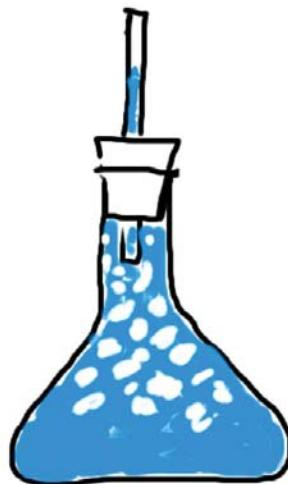
**Fig. 5.1** La cantidad de entropía a medir se transfiere a la mezcla de hielo y agua. La cantidad de hielo que se funde en el proceso es una medida de la entropía añadida.
