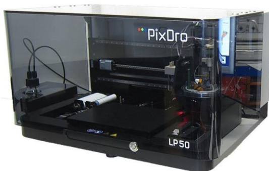
Abbildung 3.1 a) Fotografie eines Meyer Burger PixDro LP50. 107 b) Fotografie eines Dimatix DMC-11610 Druckkopfes (unten) mit zugehörigem Tintenreservoir (oben). 108
