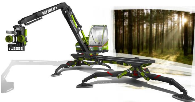
Abbildung 2.1: Portalschreitwerk mit Oberwagen und Forstkran [7]
