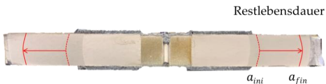
Abbildung 6-10: Exemplarische Bruchfläche einer verstärkten Probe mit zentrischem Innenriss, Darstellung der ausgewerteten Restlebensdauer
