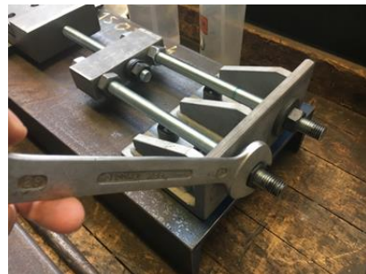
Abbildung 6-8: Einspannung der CFK-Lamellen in den Spannbacken (links), Vorspannen durch alternierendes Anziehen der Muttern (rechts)
