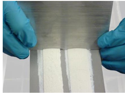
2. Auftrag des Klebstoffs (Dosierung, Abziehen)
