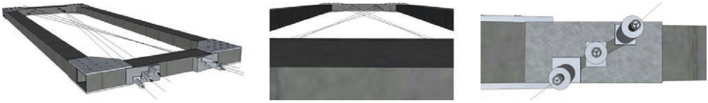
Bild 2: Entwickelter Vorspannrahmen für doppelt gekrümmte Bauteile; von links nach rechts: Rahmen mit Spanngliedern, Detail der schiefwinkligen gerade Bewehrung, Neigung der Hohlkolbenzylinder | Fig. 2: Developed prestressing frame for doubly curved elements; from left to right: frame with prestressing tendons; details of skew, but straight tendons; inclination of hollow piston cylinders
