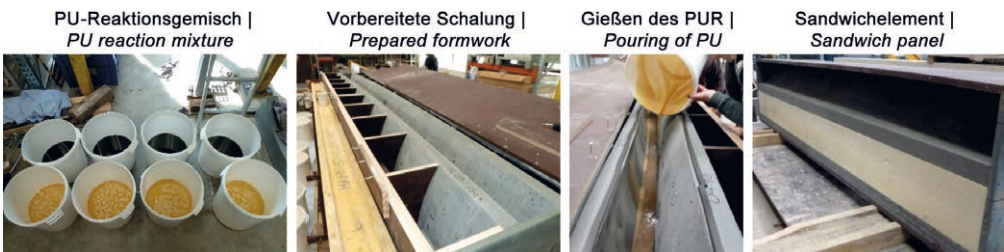
Bild 4: Herstellprozess für großformatige Sandwichelemente | Fig. 4: Production procedure for large-scale sandwich elements
