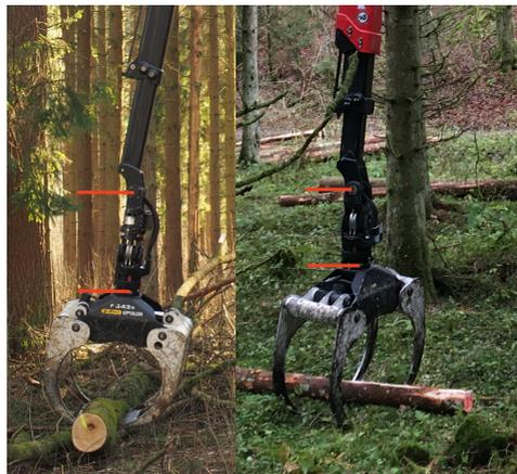
Abbildung 2.5: Einfluss einer zwischen Teleskopauge und Rotator montierten Kranwaage: Links mit Kranwaage, Rechts ohne Kranwaage
