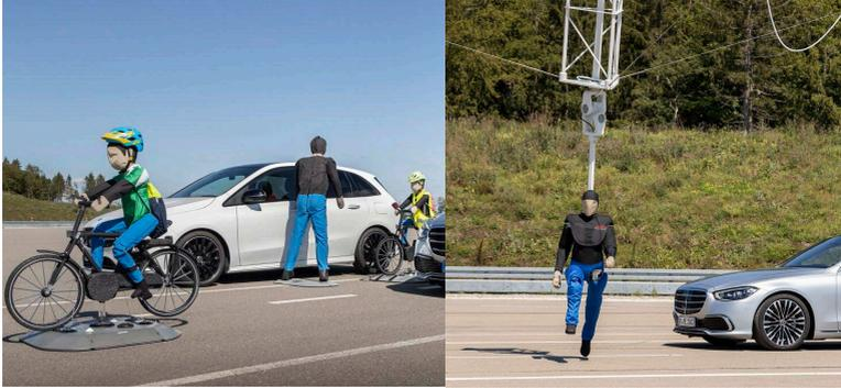
**Abbildung 2.13:** Möglichkeiten zur Bewegung von Fußgängern und Fahrradfahrern auf dem Prüfgelände (links: Freeboard aus [4], rechts: Seilsystem aus [3])
