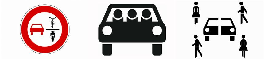
**Abbildung 2.2:** Neue Verkehrszeichen der StVO Novelle 2020 nach [105]. Überholverbot von Zweirädern (links), Mehrfachbesetzte Pkw (Mitte) und Parkplatz für Carsharing (rechts)
