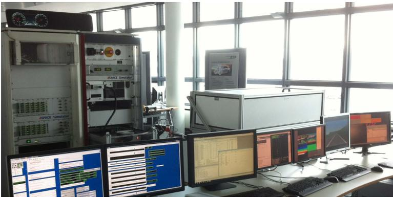
**Abbildung 5.6:** HiL-Prüfstand für Fahrerassistenzsysteme von Mercedes-Benz, an dem der vorgeschlagene Bewertungsansatz prototypisch erprobt werden konnte (Bild aus [213])
