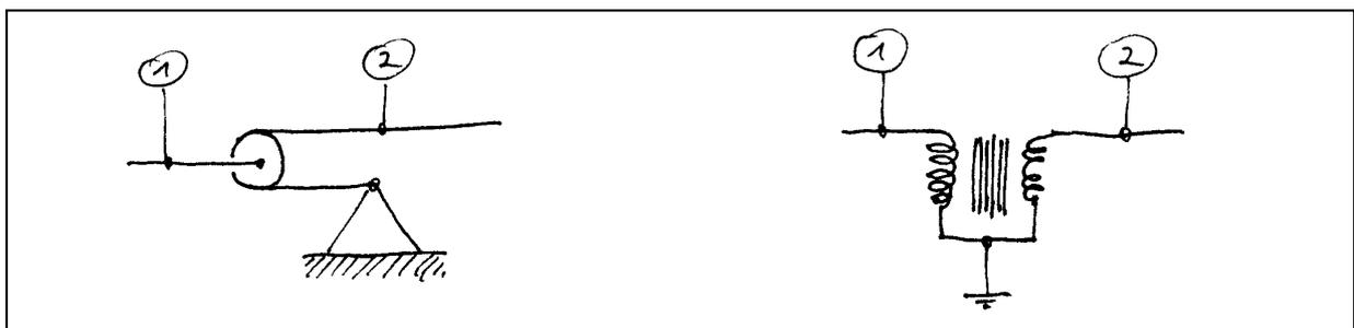
Abb. 5.7. Flaschenzug und Transformator
