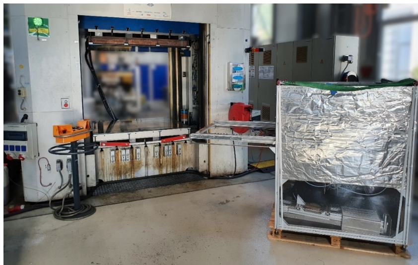
Abbildung 3-5: Bauteilherstellungsprozess am Fraunhofer ICT. Links: hydraulische Oberkolbenpresse DYL 630/500. Rechts: IR-Heizfeld mit Pyrometerregelung
