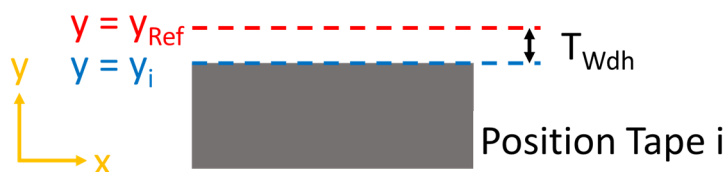
Abbildung 3-9: Schematische Darstellung der Wiederholgenauigkeit
