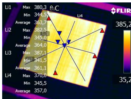
Abbildung 4-36: Thermografiebild eines Laminates nach dem Ausfahren aus dem Heizfeld
