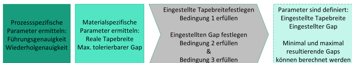
Abbildung 3-22: Methodik zur Bestimmung der Prozessparameter beim Tapelegen in Abhängigkeit der prozess- und materialspezifischen Einflussfaktoren
