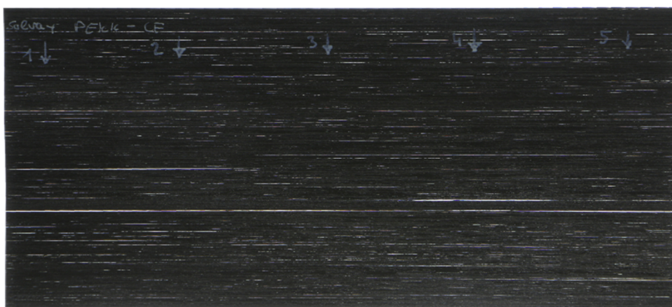
Abbildung 4-5: Aufsicht des PEKK-CF Tapes mit rückseitiger Beleuchtung
