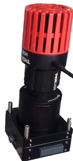
Abbildung 1.8.: Lichtquelle zur Beleuchtung der PKMZ (aus [1]).
