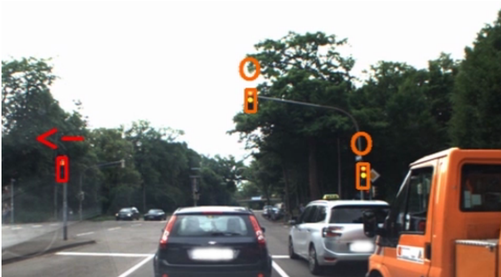
Abbildung 3.1: 2D Ampeldetektion mit Erkennung des aktuellen Zustandes und der enthaltenen Richtungsangabe. Die Farbe der Bounding Box zeigt den erkannten Zustand der Ampel, das darüber angezeigte Symbol die erkannte Richtungsinformation. Erstveröffentlichung in: [8]
