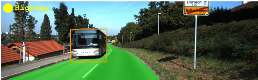
Abbildung 5.1: Ergebnis eines MultiNet-Modells für die drei Tasks Straßensegmentierung (grün), Fahrzeugdetektion (orange) und Szenenklassifikation (gelb) in einem Bild. Ähnlich veröffentlicht in: [5]
