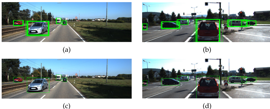
Abbildung 5.11: Beispielausgabe der Detektionskomponente aus dem MultiNet-Modell. Die oberen Bilder (a), (b) zeigen die Ausgabe vor der Nachverarbeitung, in den unteren Bildern (c), (d) ist das finale Detektionsergebnis nach der Non Maximum Suppression zu sehen. Erstveröffentlichung in: [5]
