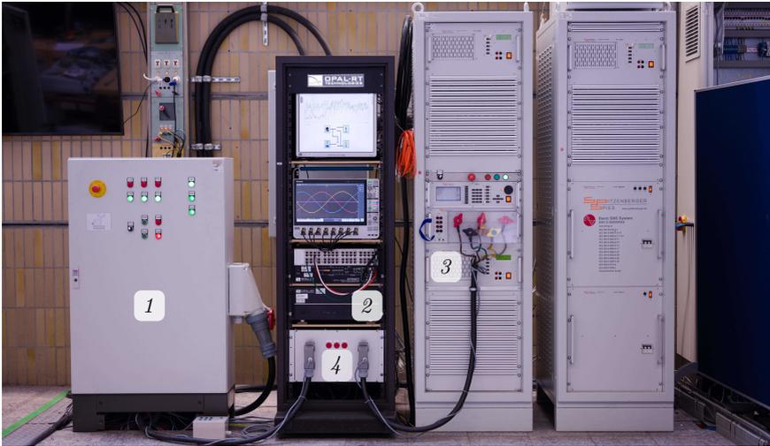
Abb. D.2: PHIL-Umgebung am IEH mit Netzumschaltung zum Anschluss des ESHL (1), Echtzeitsimulator OP5030/OP5607 (2), Verstärkersystem PAS 30000 (3) und Strommessung (4)
