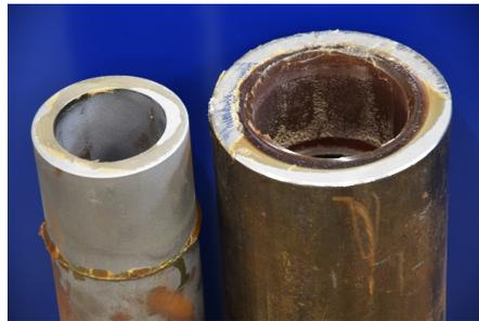
Abbildung A.6: Zugversuche an geklebten KHP-Steckverbindungen: Exemplarische Versagens- und Bruchbilder für die Konfiguration A (oben) und C (unten) mit einer Überlapp-länge von 60 mm; Klebstoff EPH
