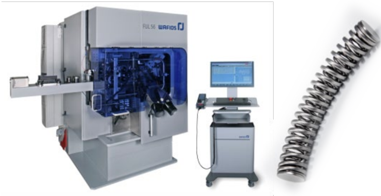
Abbildung 7.5: Links: Im Anwendungsfall untersuchte Federwindmaschine (Wafios AG, 2021); Rechts: beispielhaft dargestellte Bogenfeder (Brand KG, 2020)
