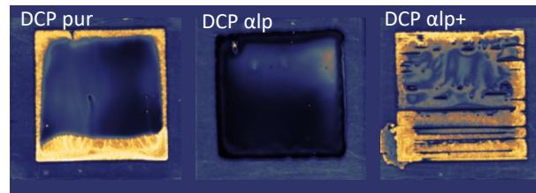
Abbildung A.1.2: Auswirkungen der Konzentration des amphoterischen Tensids \alpha LP auf Benetzung und Trocknung der DCP-Tinte auf ITO-Substraten. Die drei gezeigten DCP-Schichten sind gedruckt mit einer DCP-Tinte ohne \alpha LP, mit ca. 11,7 \mu\text{g}/\text{mL} und ca. 23,4 \mu\text{g}/\text{mL} \alpha LP in der Tinte. Eine zu hohe Konzentration führt zur Entnetzung. Die Reflexions-Falschfarbenbilder sind mit dem In-Situ -PL-Aufbau aufgenommen, wobei die beiden äußeren Aufnahmen nach dem Vakuumtrocknen und Ausheizen und die innere Schicht während der Vakuumtrocknung vor dem Ausheizen aufgenommen wurde.
