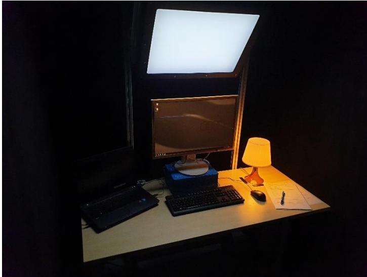
**Abbildung 4.1:** Versuchsumgebung mit Büroarbeitsplatz und überkopf Lichtpanel, welches das Szenario *große Leuchte* zeigt (aus [222])
