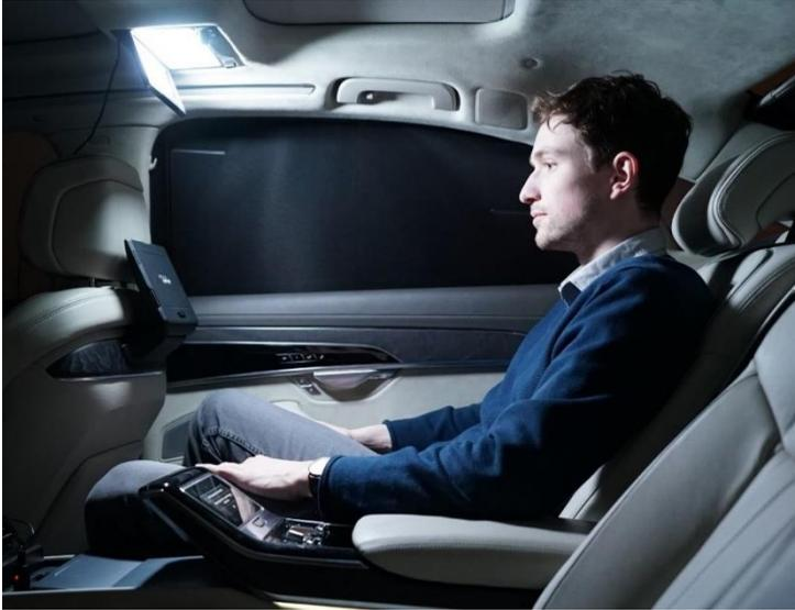
**Abbildung 4.4:** Modifizierte Audi A8 Make-Up Leuchte mit ausgeklapptem Spiegel zur Maximierung der wahrgenommenen Leuchtfläche (aus [224])
