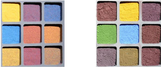
**Abbildung 8.2** Setzkästen mit Quarzsandmischungen links und Farbpulvermischungen rechts [V7, V10].
