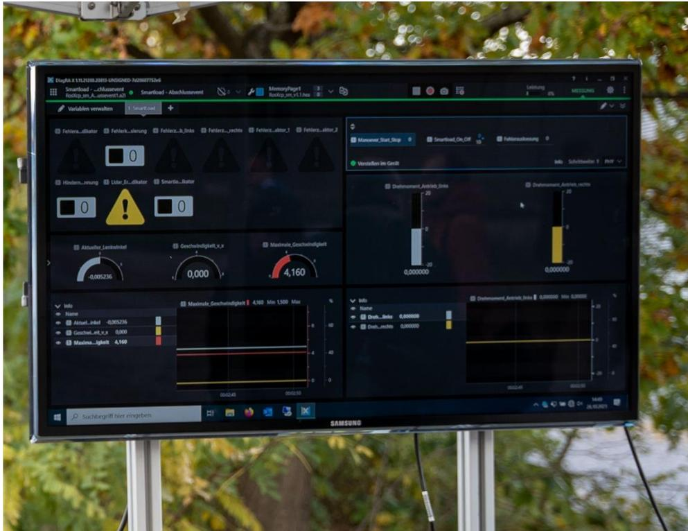
Abbildung 16: Leitstand bereitgestellt vom Projektpartner RAC mit Schnittstelle über Telemetrie auf Steuergeräte des Demonstratorfahrzeug
