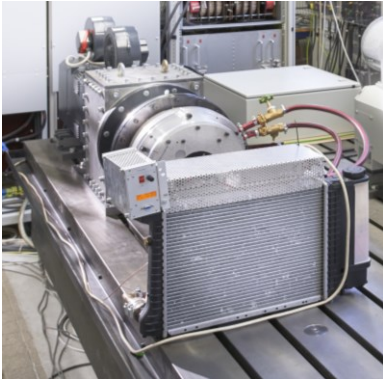
Abbildung 4.1: Im linken Bild ist der Maschinensatz mit Lastmaschine (hinten), Prüfling (Mitte) und Kühleinheit (vorne) gezeigt. (Foto: Amadeus Bramsiepe, KIT), rechts der in der FE-Rechnung hinterlegte Maschinenschnitt
