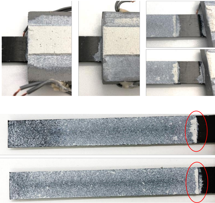
Abbildung 5-13: Exemplarische Fotos der Bruchflächen mit Hervorhebung der Bruchkeile (Probe: S1-A, Klebstoff: MC-DUR 1280)
