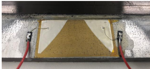
Abbildung 2-8: Auf einem Stahlblech aufgeklebter Rissfortschrittsmessstreifen
