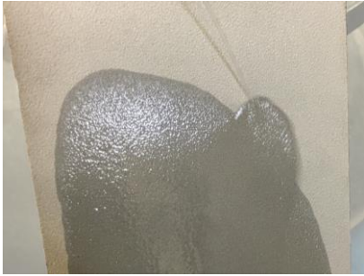
1. Entfettung der gestrahlten Stahl- fläche mit Aceton
