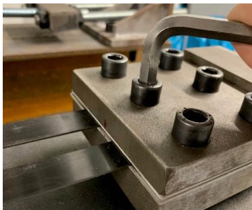
Abbildung 6-8: Einspannung der CFK-Lamellen in den Spannbacken (links), Vorspannen durch alternierendes Anziehen der Muttern (rechts)
