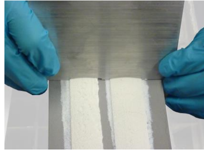
2. Auftrag des Klebstoffs (Dosierung, Abziehen)
