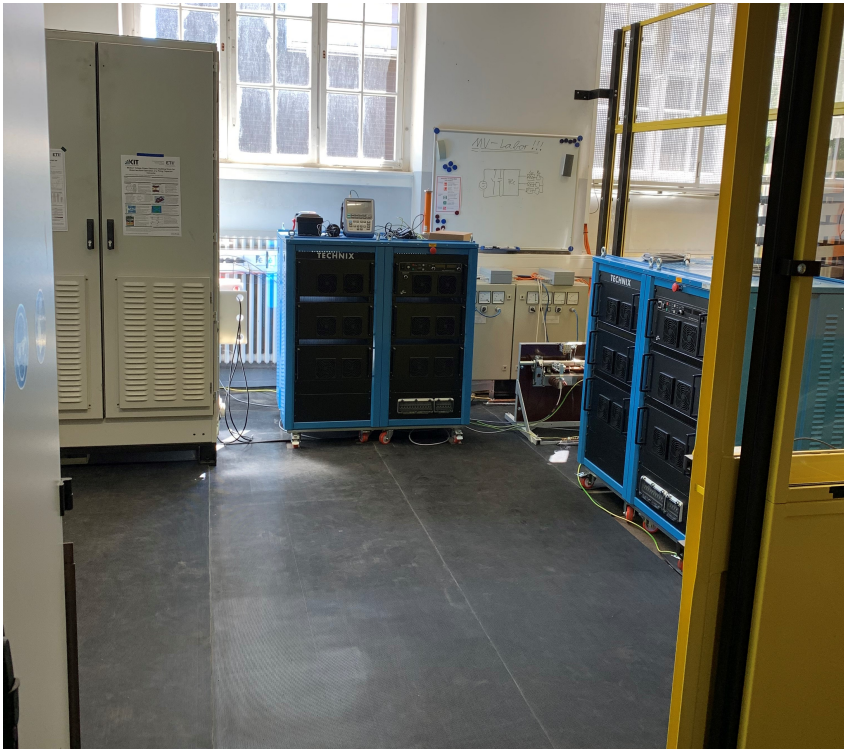
Abbildung 6.1: Bild des Prüfplatzes für hochdynamische Mittelspannungsumrichter
