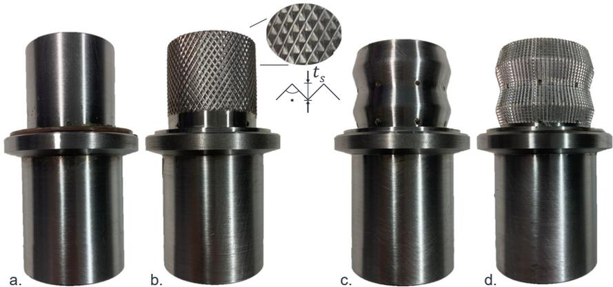
**Abbildung 4.3:** Metallische Lasteinleitungselemente mit verschiedenen Oberflächenbehandlungen: (a) Lasteinleitungselement für Stoffschluss ohne Oberflächenbehandlung, (b) Strukturierung für Stoffschluss mit  $30^\circ$  Orientierung und  $0,7 \text{ mm}$  Tiefe, (c) Formschlüssiges Lasteinleitungselement ohne Oberflächenbehandlung, (d) Multiskalenformschlusselement mit schachbrettförmigen  $0^\circ$ - $90^\circ$  Strukturierungen bei Tiefen von  $0,7 \text{ mm}$
