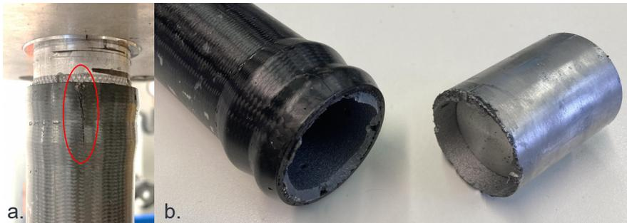
Abbildung 5.27: (a) Risswachstum des Referenzbauteils während der Prüfung, (b) Geprüfter Versuchskörper der optimierten Variante mit Versagen des 3D-gedruckten Lasteinleitungselements im Bereich der Entlüftungsbohrungen
