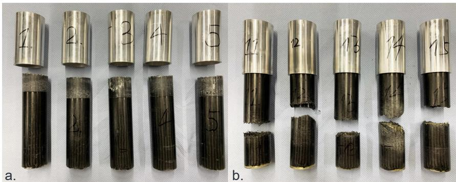
Abbildung 5.19: Geprüfte FKV-Metall-Bauteile hergestellt bei (a) Raumtemperatur und (b) Prozesstemperatur (A\_Zhao 2021, S. 51-52)
