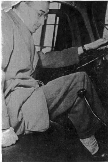
Abbildung 5.6: Beengtheit eines nicht nach ergonomischen Prinzipien konstruierten Fahrerplatzes, aus: McFarland: Human Limitations and Vehicle Design, S. 8.
