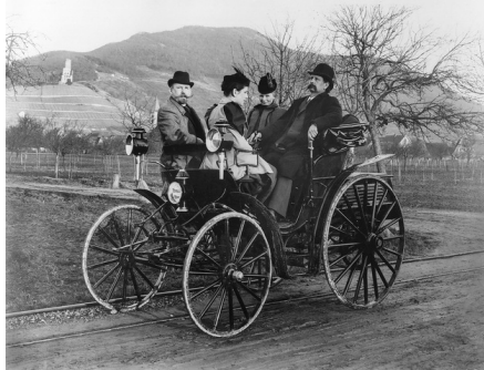
Abbildung 5.8: Vis-à-vis Sitzanordnung des Benz Victoria 1893; Quelle: Mercedes-Benz Classic (Archivnummer H3072).
