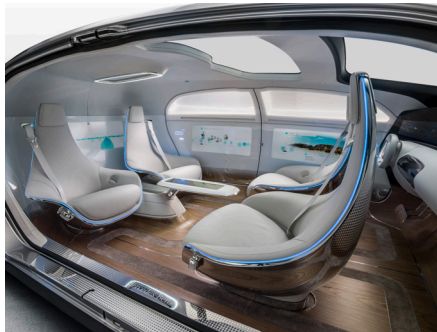
Abbildung 5.9: Konzeptwagen F015 von Mercedes-Benz mit Vis-à-vis-Anordnung der Sitze; Quelle: Mercedes-Benz AG (Ablagenummer: 14C1450_067).
