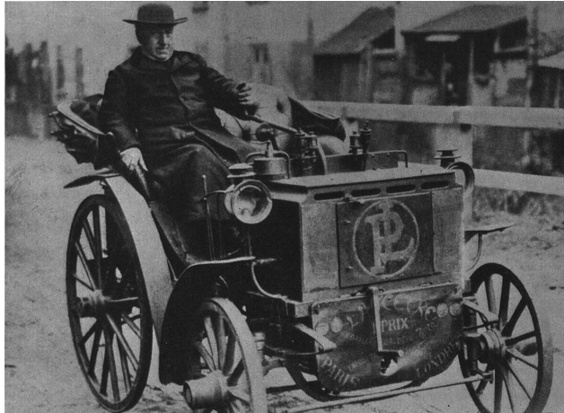
Abbildung 1.2: Wagen der Marke Panhard-Levassor mit vornestehendem Motor aus dem Jahr 1891; aus: Diesel: Wir und das Auto, S. 6.
