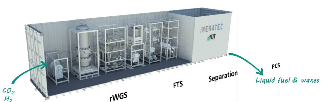
Abbildung 30: Synthese-Container zur Herstellung von Fischer-Tropsch-Kraftstoffen aus CO 2 und Wasserstoff am EnergyLab 2.0 (Bild: Ineratec GmbH)
