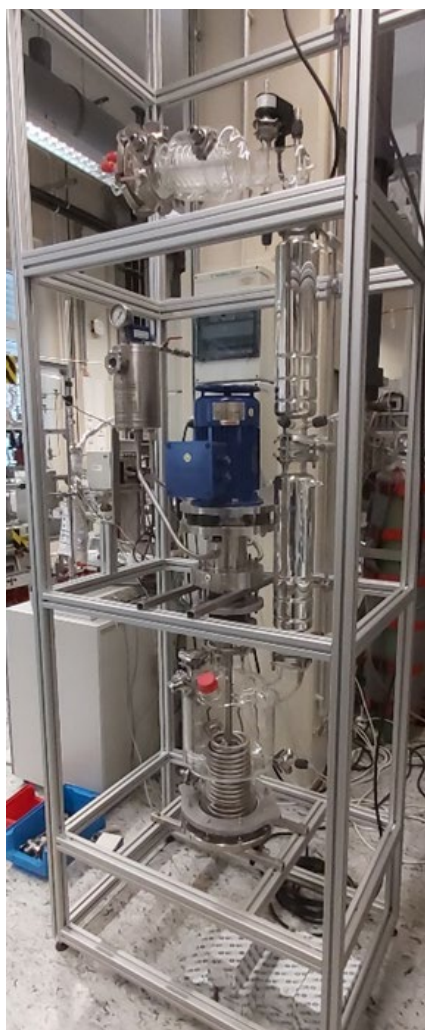
Abbildung 34: Vakuumdestillationsanlage für kleine Chargen im Technikum des IMVT.
