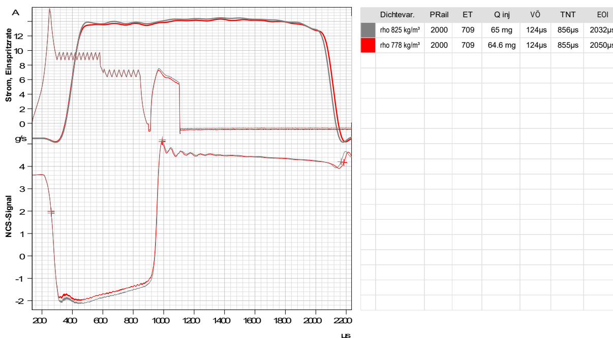
Abbildung 45 Wirkung des Dichteeffekts auf Einspritzrate und Merkmalerkennung NCC
