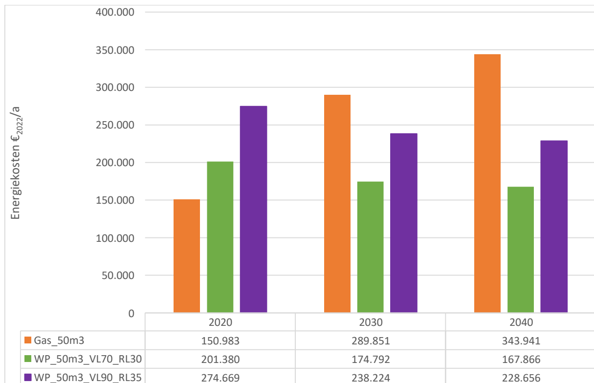
Abbildung 39 Simulierte Energiekosten des Referenzsystems und des Untersuchungssystems mit 2 unterschiedlichen Temperaturniveaus bei Stromkosten im Fixpreis Szenario, Quelle: Eigene Darstellung
