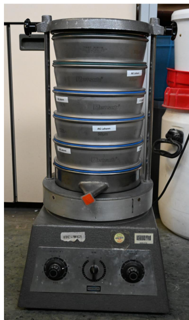
Abbildung A.4.: Der Siebturm ermöglicht den Einsatz von Wirbelschichten mit definierter Größenverteilung
