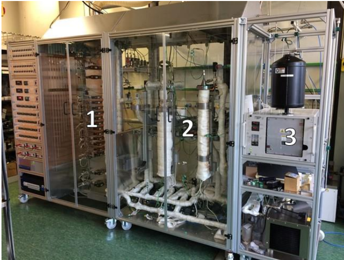
Abbildung 3.1: Aufbau der Anlage: die Vorheizstrecke (1) , der Gegenstromreaktor (2) und die Gasanalyse (3).
