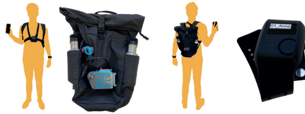
Bild 2: Schematische Darstellung des Sensorequipments mit Smartphone, Empatica E4, GoPro-Kamera sowie zum OpenWalkSensor umgebauten OpenBikeSensor. © Zeile et al.
