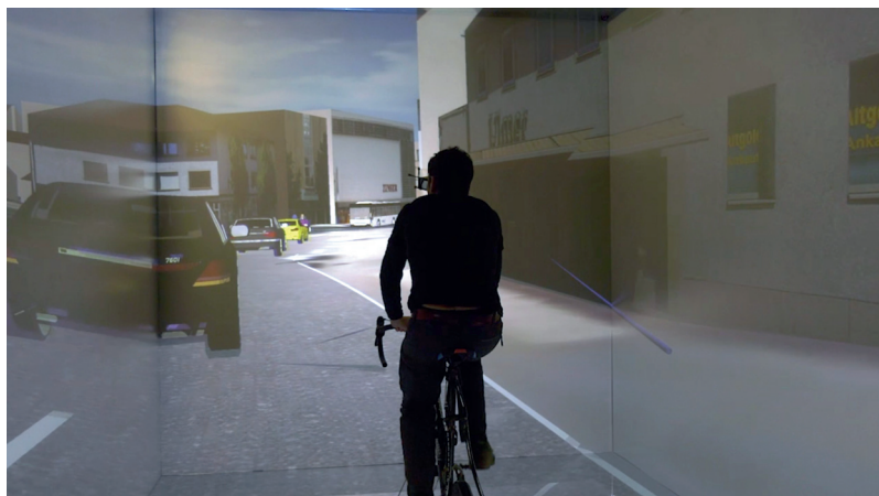
Bild 6: Digitaler Zwilling in Herrenberg in der CAVE mit Fahrradsimulator © Zeile et al.
