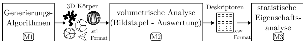
Abbildung 3.13: Schematische Darstellung der Routine zur Generierung virtueller Nanopartikel-(NP) Kollektive gekoppelt mit einer statistischen Auswertung der Partikeleigenschaftsverteilung (PEV).
