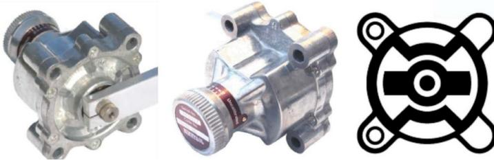
Abbildung 2.35: Rotatorisch wirksamer Dämpfer, basierend auf dem Prinzip der Fluidrosselung. Die Fluidverdrängung erfolgt durch einen Flügelmechanismus im Inneren, der mit der Ausgangswelle verbunden ist. Über Fluidkanäle zum Einstellventil erfolgt ein Volumenstrom. Abbildung aus (Mangold, 2019, S. 168). Einzelabbildungen aus (Kinetrol Ltd., o.D.)
