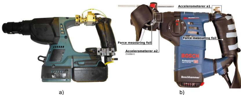
Abbildung 2.3: Exemplarische handgehaltene Maschinen zur Messung von Greifkräften während der Anwendung: a) modifizierter Hauptgriff (Matthiesen, Mangold & Bruchmüller, 2018), b) Nutzung von Kraftmessfolien (Lindenmann et al., 2021).
