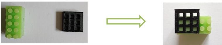
Abbildung D 11: Stecksystem zur Montage der Elastomere an die Griffaufnahme. (Leisering, 2021)
