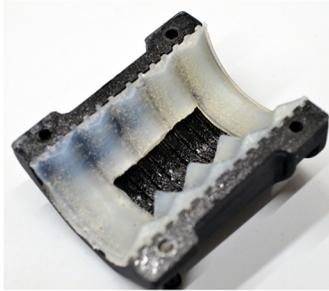
Abbildung 6.28: Modifizierte Elastomereinlage (Silikon Shore-00-20, hier ohne Farbpigmente). In iterativen Testmessungen wurden zur dynamischen Abstimmung des HAM Teile des Elastomers in beiden Halbschalen entfernt.
