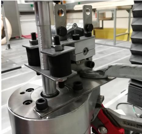
Abbildung D 2: Rotationsdämpfer mit Hebeladaption und Elastomerkopplung. Der Rotationsdämpfer ist über eine Blechaufnahme stirnseitig am anpassbaren Steifigkeitselement angebracht. Abbildung aus: (F. Krause, 2021, S. 36)
