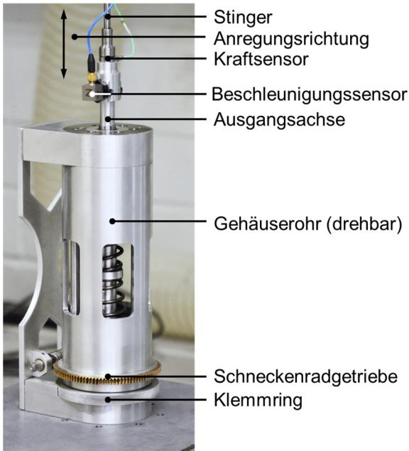
Abbildung 6.10: Versuchsaufbau zur Messung der MI des ASE mittels des Shakerprüfstandes. Der Shaker wirkt in vertikaler Richtung und ist über einen Stinger mit dem ASE gekoppelt. Basierend auf (Lindemann et al., 2022b)
