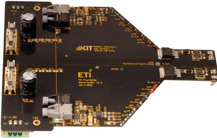
Abbildung 5.8: Bild der Gate-Treiber Platine
