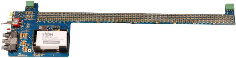
Abbildung 5.11: Bild der Spannungsmessplatine
