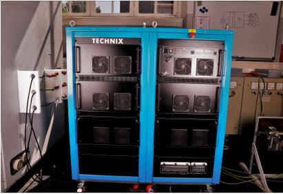
(a) MV-DC-Netzteil für bis zu 12 kV
