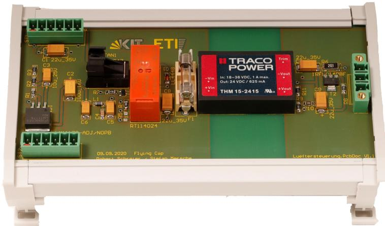
Abbildung 5.13: Bild der Lüftersteuerungsplatine
