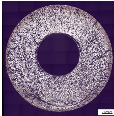
Abbildung 5.16: Bruchfläche einer bei \varepsilon_a = 0.7\% und T = 180\text{ °C} geprüften Schweißprobe
