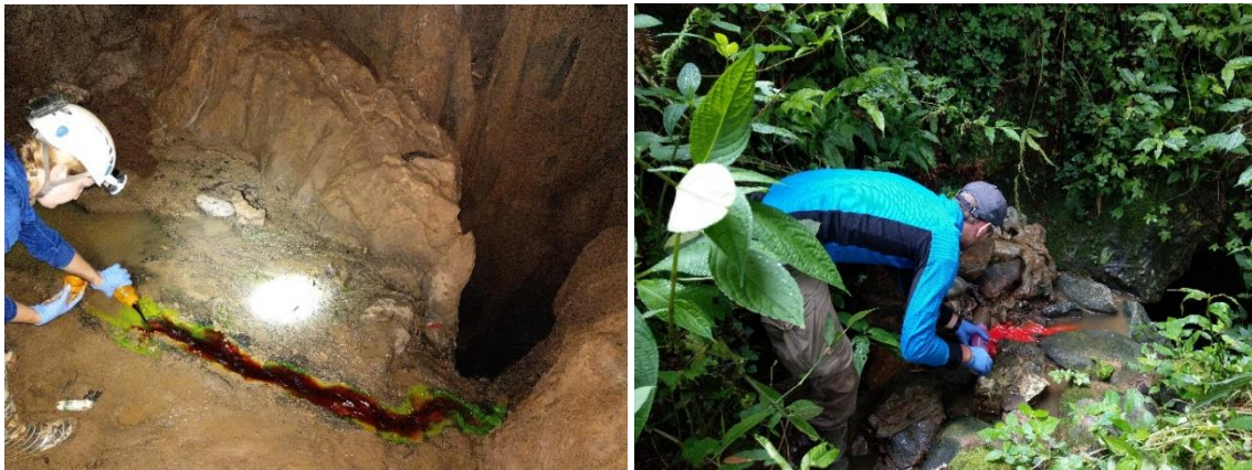
Figure 11: Tracereingabe in die Schlucklöcher 1 (links; Uranin) und 2 (rechts; AmidoG).
