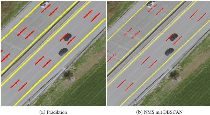
Abbildung 6.13: Prädiktion und Non-Maximum-Suppression (NMS) mit DBSCAN auf dem KAI-Testdatensatz veröffentlicht in [MSPS21]. Die Farben visualisieren die Klasse der Markierungen: durchgezogen (gelb) und gestrichelt (rot). Bildquelle der Luftbilder: ©Stadt Karlsruhe | Liegenschaftsamt
