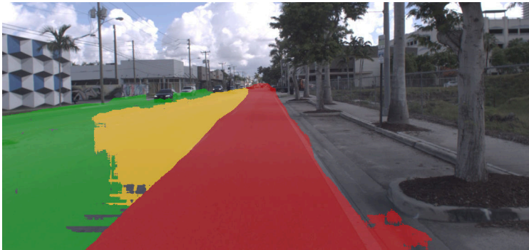
Abbildung 3.1: Fehlerhafte semantische Segmentierung der Fahrstreifen [MSOS18] auf dem Argoverse-Datensatz (Training auf Cityscapes).
