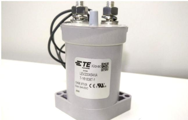
Abbildung 17: 500 A DC-Relais mit 6 W Ansteuerleistung und etwa 0,2 Ohm ON-Widerstand
