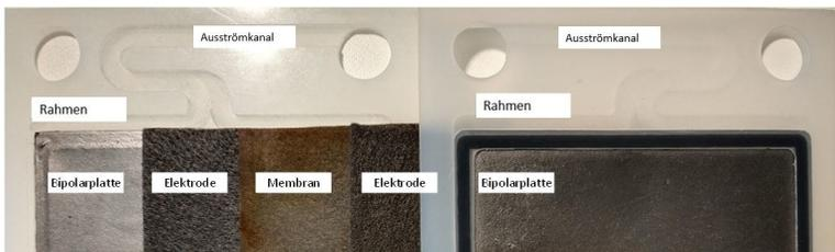
Abbildung 61: Aufbau einer Redox-Flow-Zelle
