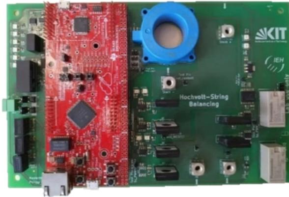
Abbildung 64: MOSFET-Balancing-Testschaltung aus [110]
