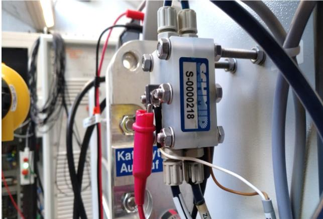
Abbildung 8: OCV-Zelle der SCHMID-Testbatterie am KIT (Karlsruher Institut für Technologie).
